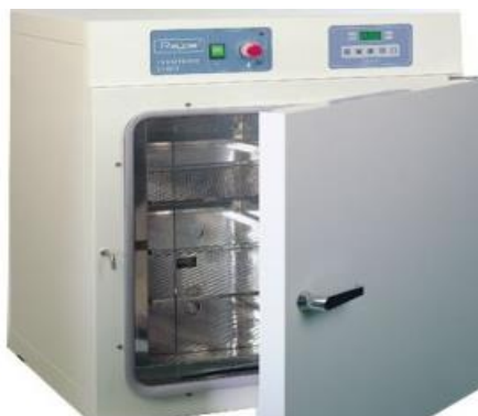
Secado de fibra de vidrio a 105 °C
