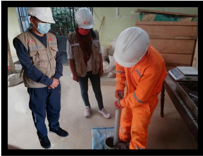
Fotografía 9. Procedimiento para compactar el suelo para el CBR
