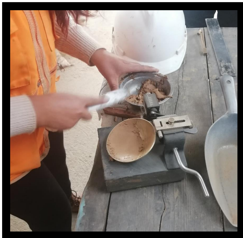
Fotografía 8: Copa Casagrande para hallar el límite líquido de la calicata
