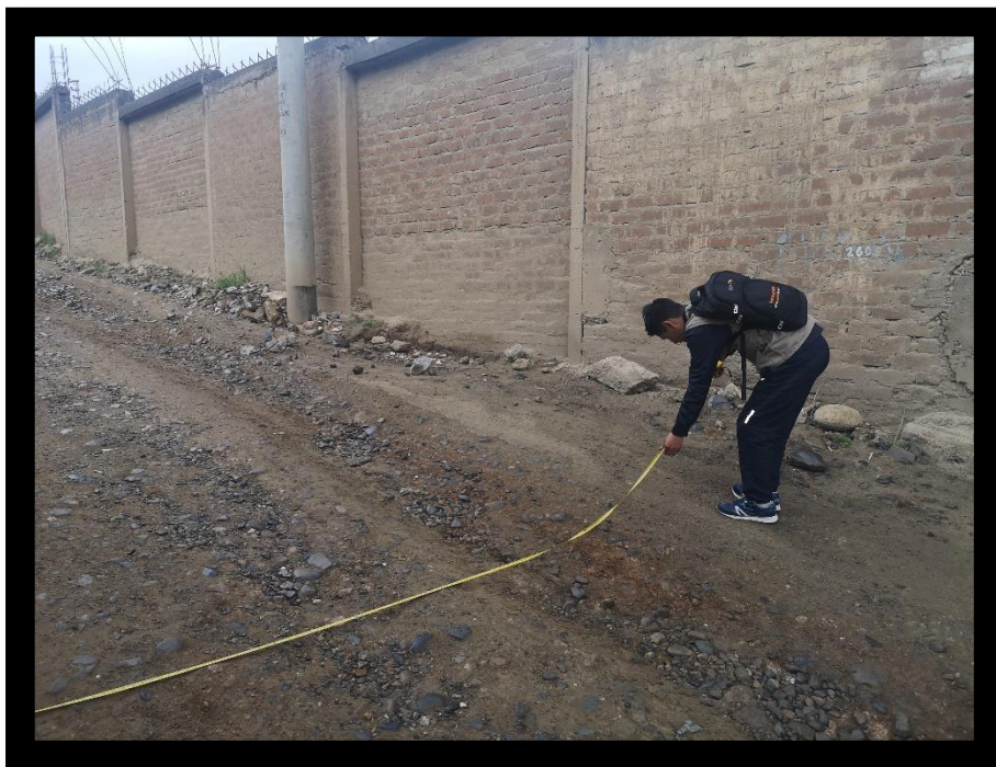
Fotografía 2: Medición del ancho de la carretera.
