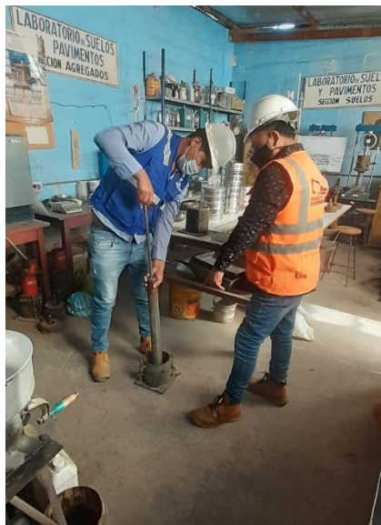
Figura 38. Compactación a 25 golpes
