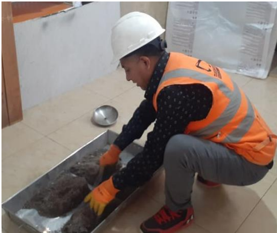
Figura 24. Separación por cuarteo
