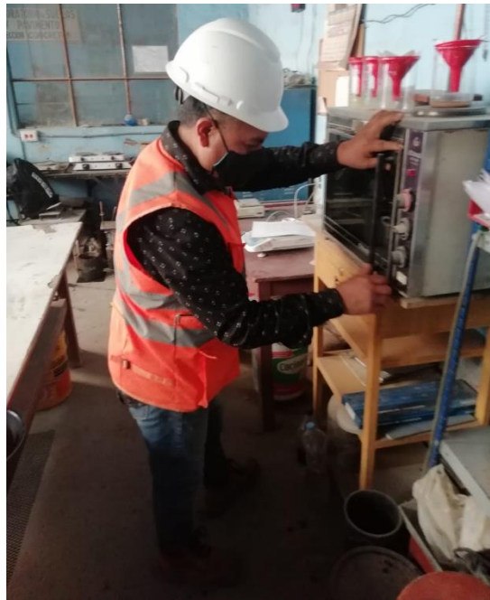
Figura 30. Muestra al horno a una temperatura 110°C
