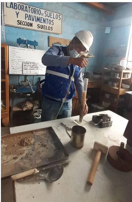
Figura 33. colocación de tubo irrigador
