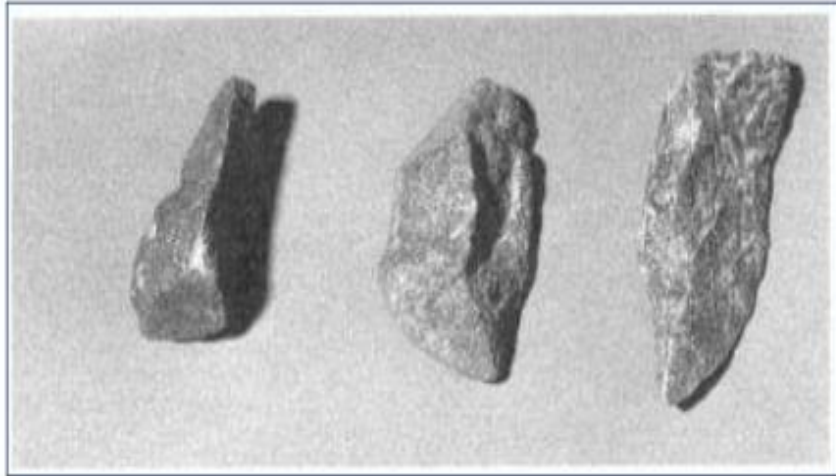
Figura 15. Fractura de la piedra rugosa para la estabilización de la base.
