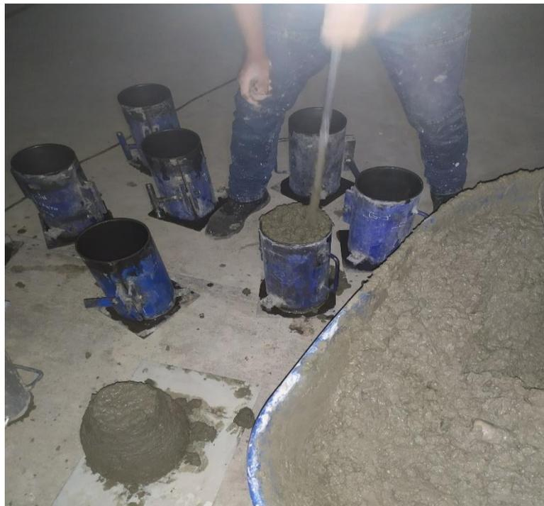
Figura 45: Chuzado de Probetas Estandarizadas de  $r=7.5$  y  $h=30$  cm para concreto  $f'c=210 \text{ kg/cm}^2$
