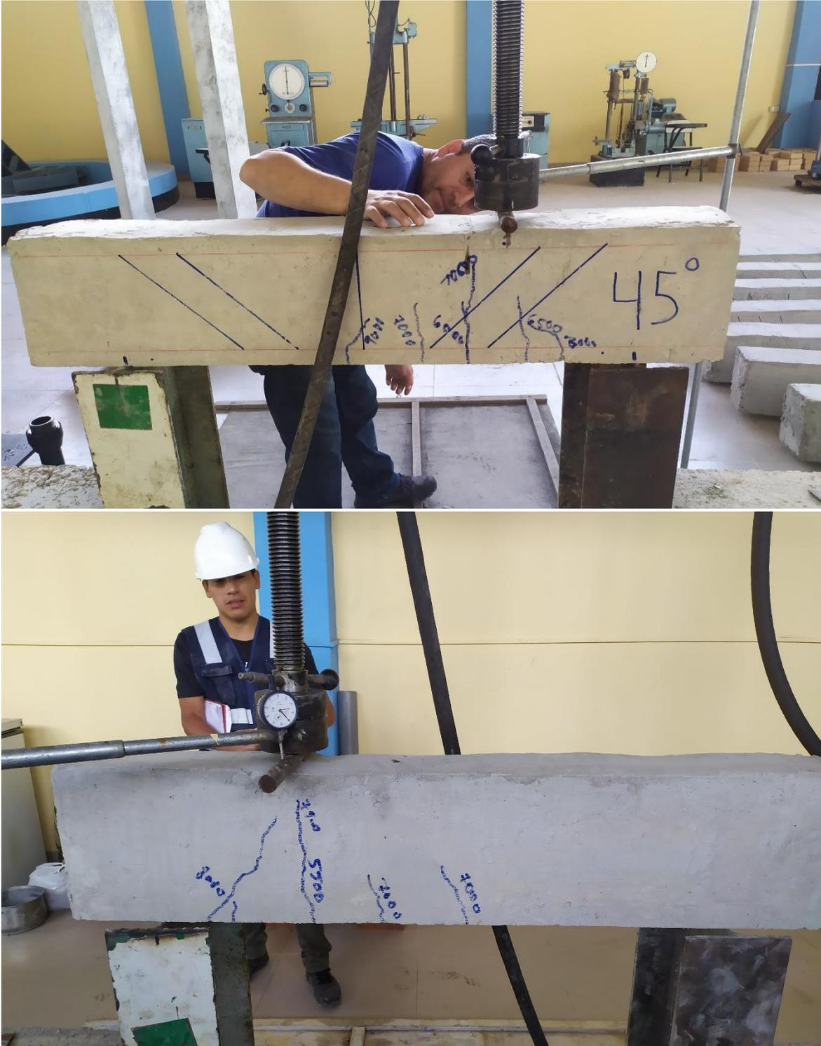
Figura 54: Grietas generadas por falla a esfuerzo cortante (caras laterales) con estribos a 45°
