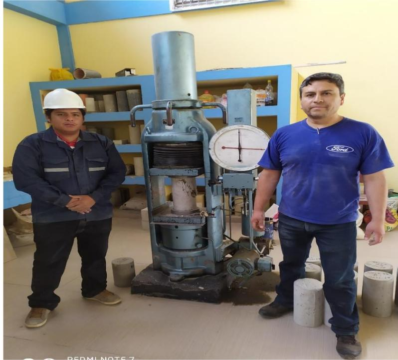
Figura 46: Rotura de probetas a los 28 días para un concreto de resistencia a la compresión de 210 Kg/cm<sup>2</sup>, en el Laboratorio de resistencia de Materiales de la UNC.
