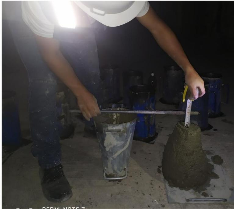
Figura 44: Medición de slump de 3" para concreto  $f'c=210 \text{ kg/cm}^2$
