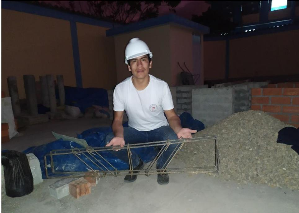
Figura 48: Armadura de viga tipo III (con estribos de 45°)
