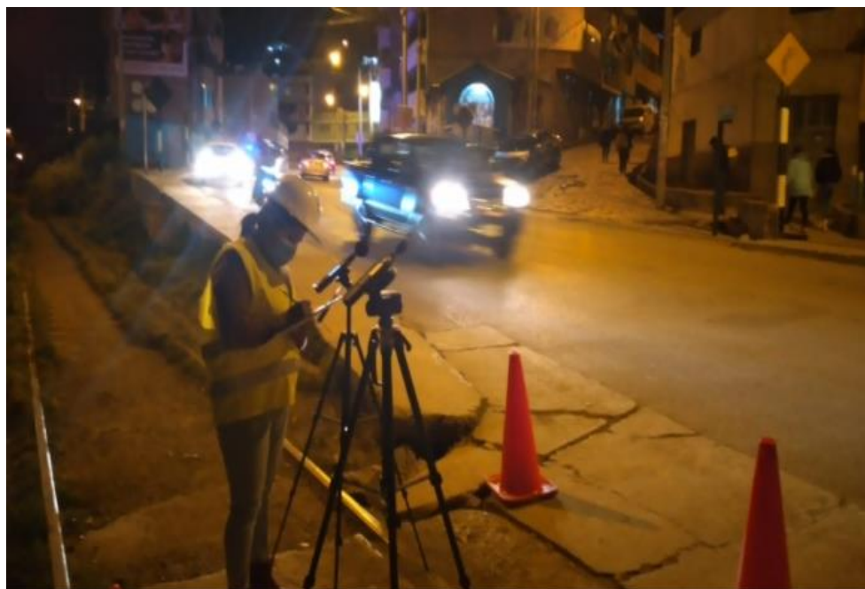
Foto 8. Toma de datos del sonómetro en la avenida Celestino Manchego Muñoz con intersección avenida Los Incas
