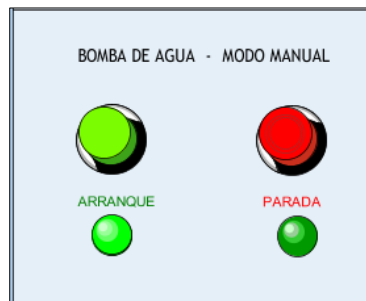
Figura 62. Encendido de bomba de agua
