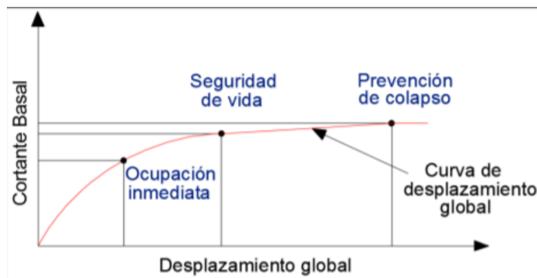
Figura 1: Curva de capacidad de cortante Basal Vs desplazamiento global según FEMA:
