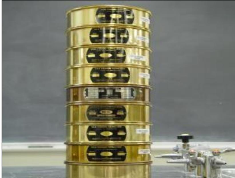
Figura 6: Tamices (Mallas para tamizado)
