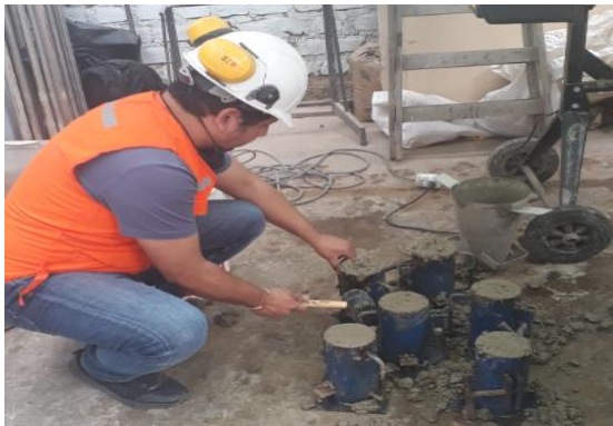
Elaboración de probetas de concreto
