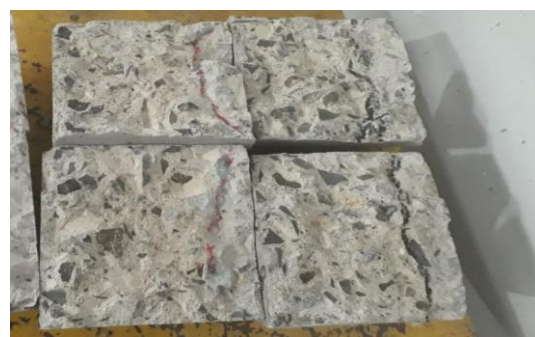
Probetas mostrando la penetración de agua en concreto con 8% de microsilíce.
