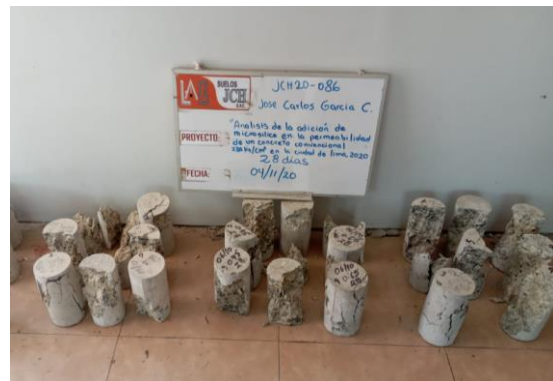
Ensayo de resistencia a la compresión a los 28 días de edad.
