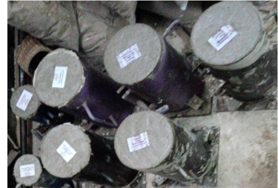
Probetas de concreto 15x30cm para ejecutar los ensayos de penetración al agua.
