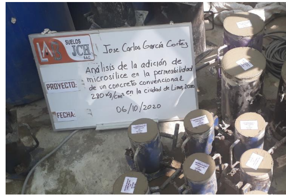
Probetas de concreto para ejecutar los ensayos al concreto endurecido.
