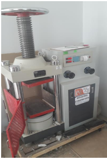
Prensa para ensayo de resistencia a la compresión de probetas.
