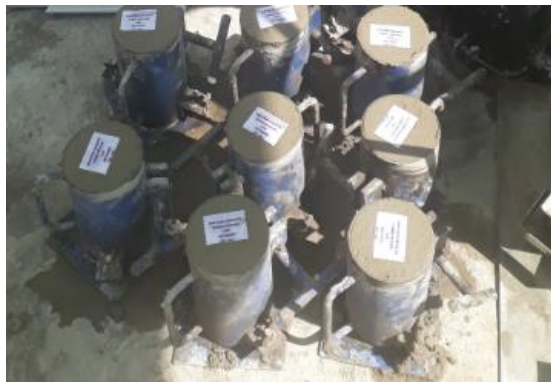
Probetas de concreto 10x20cm para ejecutar los ensayos de resistencia a la compresión.
