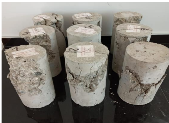
Ensayo de resistencia a la compresión a los 7 días de edad.
