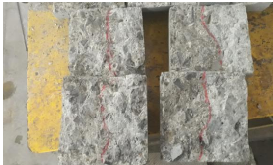
Probetas mostrando la penetración de agua en concreto con 0% de microsilíce.
