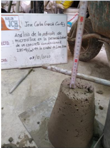
Medición de slump en concreto fresco.
