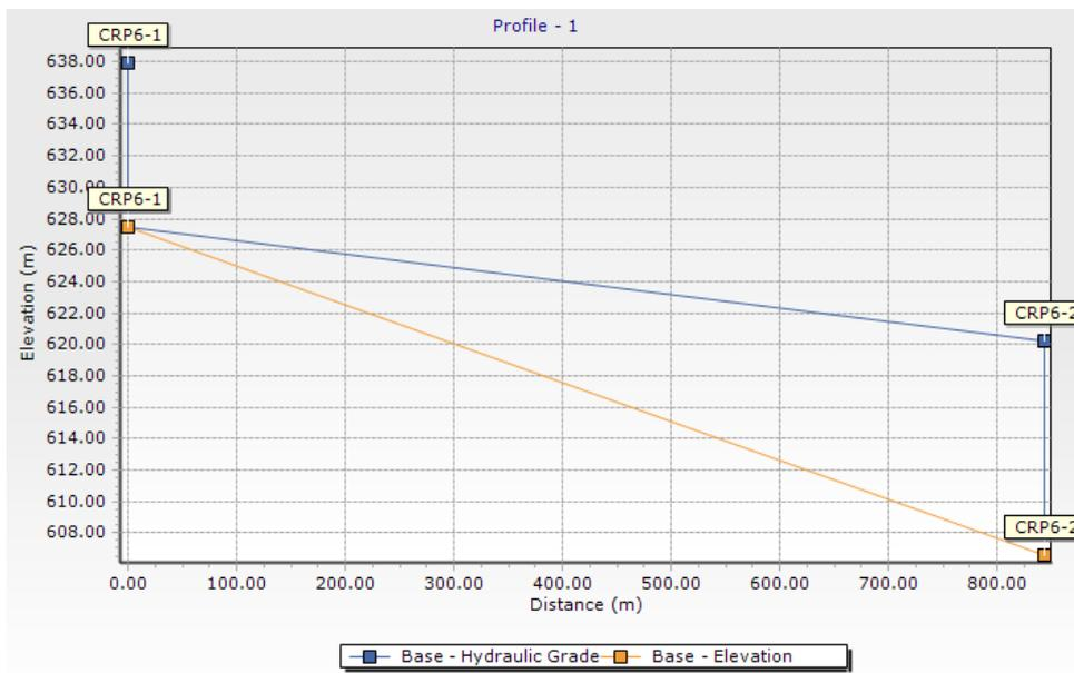
Figura 6. Perfil hidráulico Tramo CRP6-1 a CRP6-2 (Elaboración: propia)
