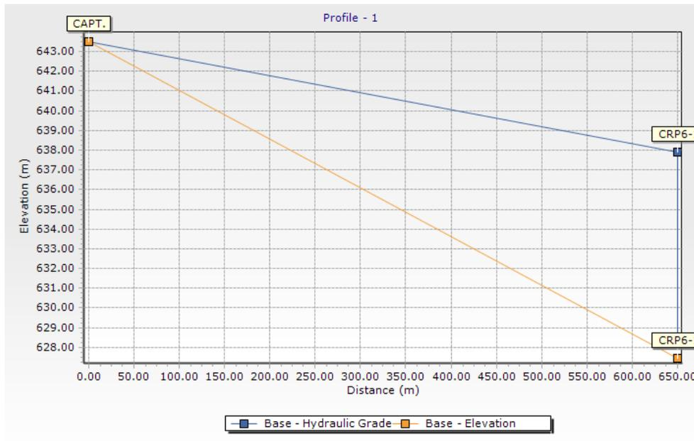
Figura 5. Perfil hidráulico Tramo Captación a CRP6-1 (Elaboración: propia)
