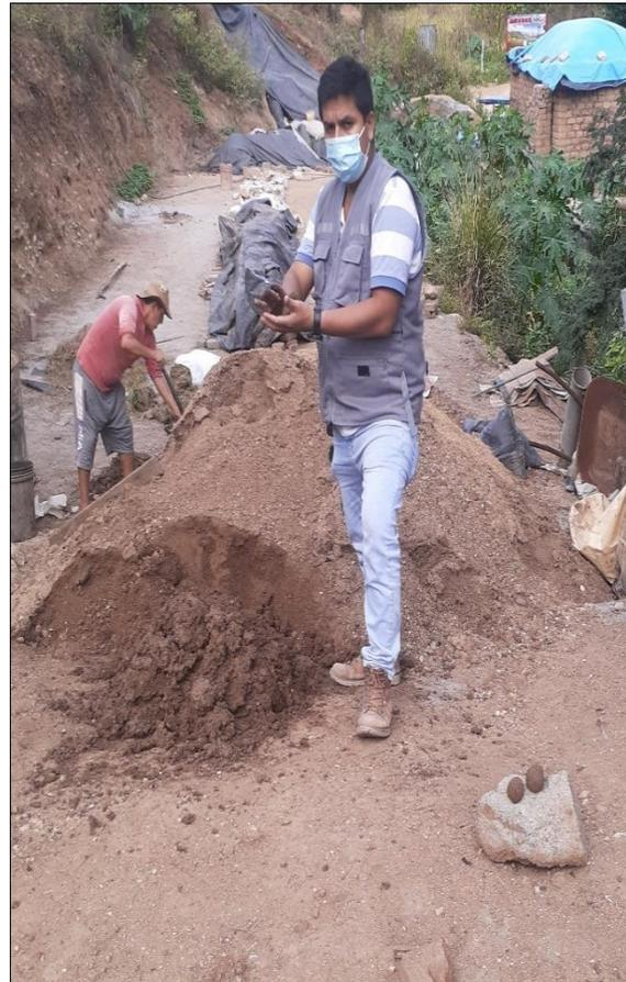
Foto N° 3: Realización de las bolitas para la resistencia seca
