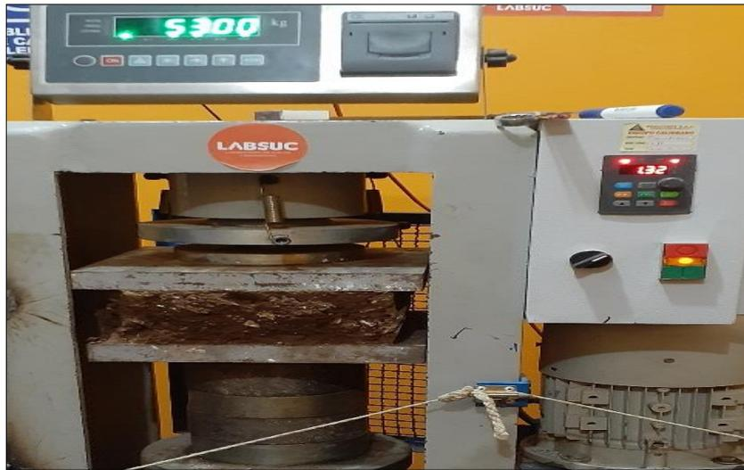
Figura 5: Prueba de Resistencia a la Compresión en el Laboratorio
