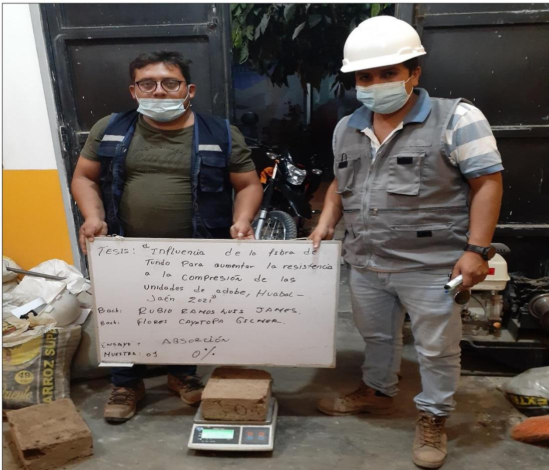
Foto N° 33: pesando para el ensayo de absorción al 0.00 % en seco.
