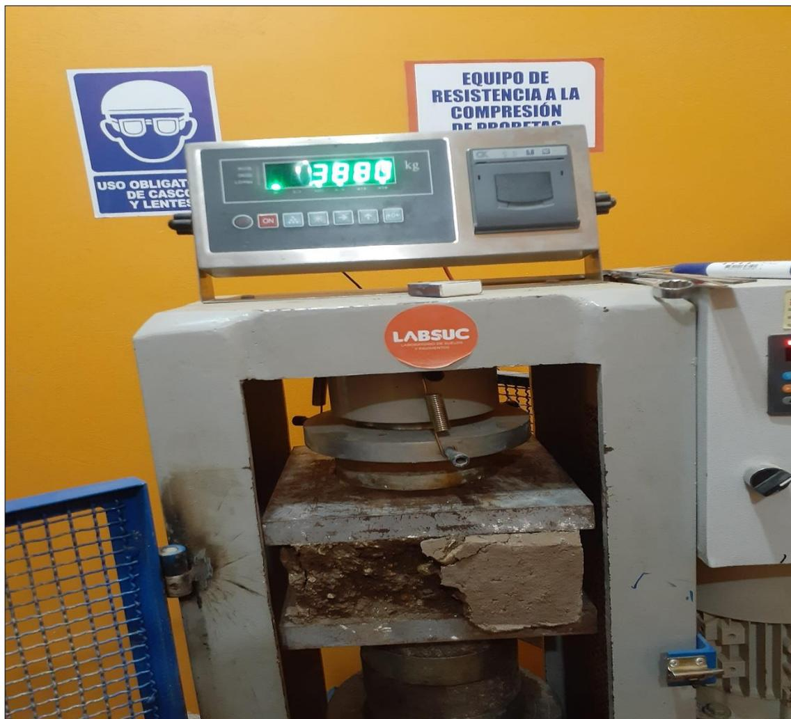
Foto N ° 28: Rotura a la compresión al 0.00% de fibra de tundo.
