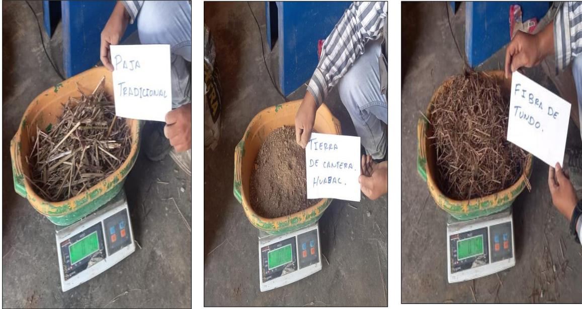
Fotos N° 9: de los insumos para la dosificación de la muestra 2 con el 5.00% de fibra de tundo.
