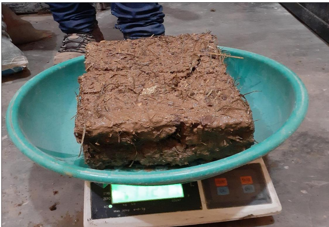
Foto N° 36: pesando el adobe sumergido al 5.00% de fibra de tundo.
