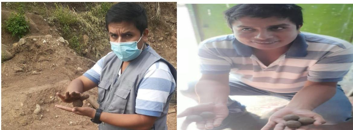
Ilustración 4: Prueba de resistencia seca.
