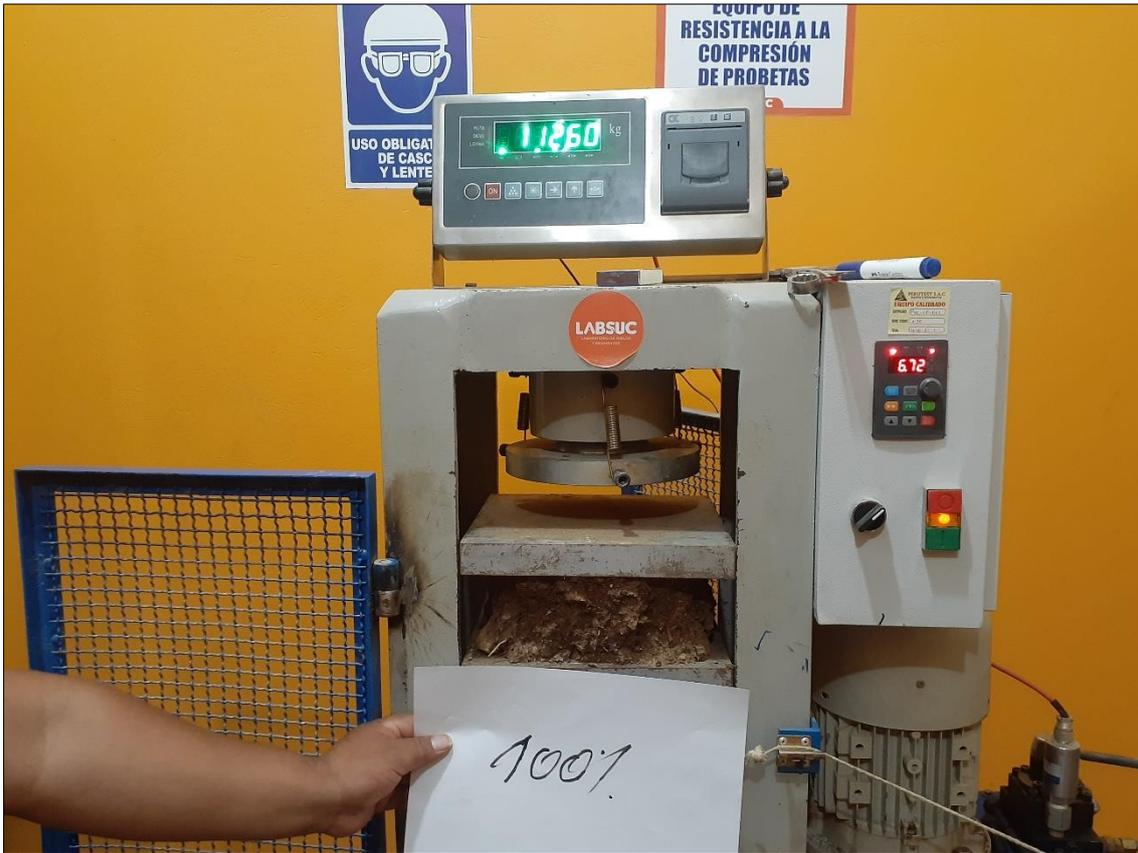
Foto N°31: Rotura a la resistencia a la compresión al 10.0%
