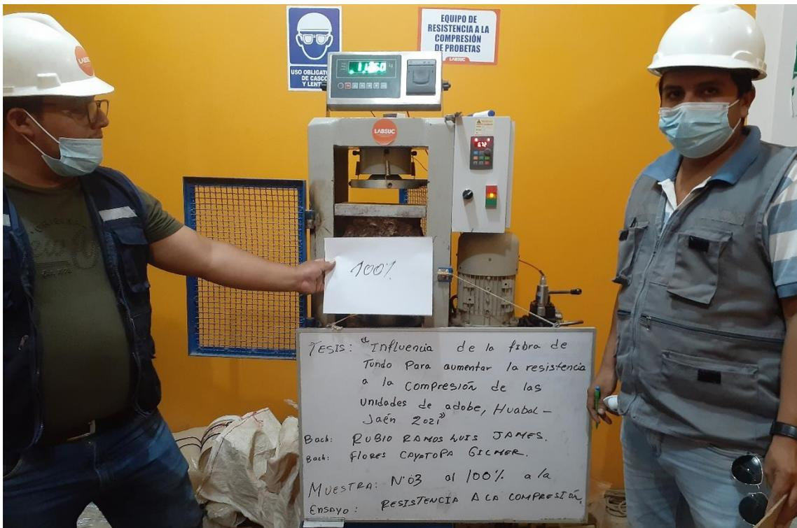
Foto N° 32 Rotura a la resistencia a la compresión al 10.00 %.
