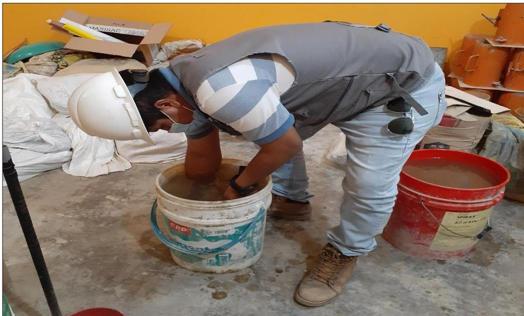
Foto N° 34: sumergiendo el adobe al agua la muestra para la muestra 1 al 0.00 %.
