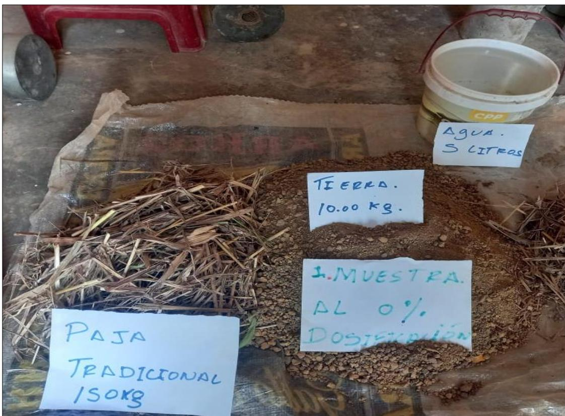
Foto N°8 Dosificación para la muestra patrón al 0.00%.
