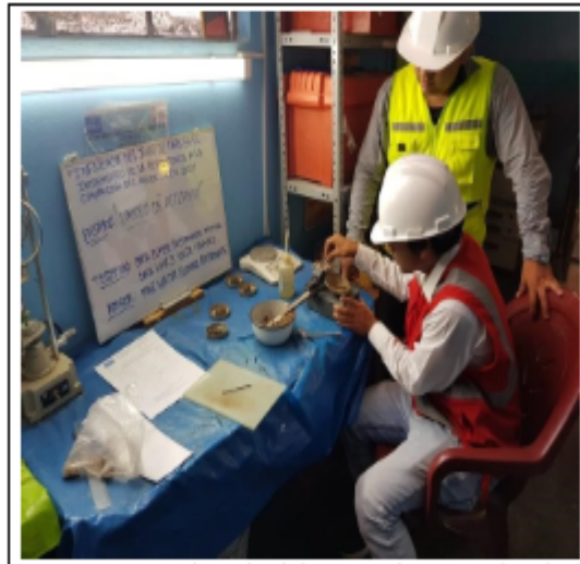
IMAGEN 17. Realización del ensayo de Limite Líquido.
