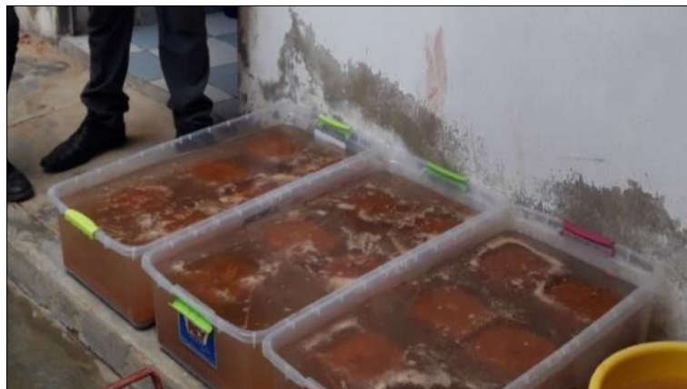
FIGURA 03: Procedimiento para calcular el porcentaje de absorción del adobe
