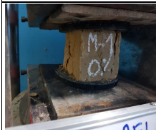
IMAGEN 39. Se observa la Grieta, falla del bloque
