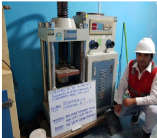
IMAGEN 43. ROTURA BLOQUE M-3=5%
