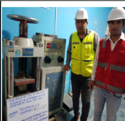
IMAGEN 41. Ensayo de compresión del cubo.
