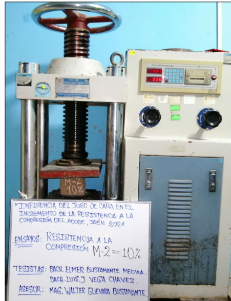
FIGURA 02: Equipo de ensayo a la resistencia a Compresión
