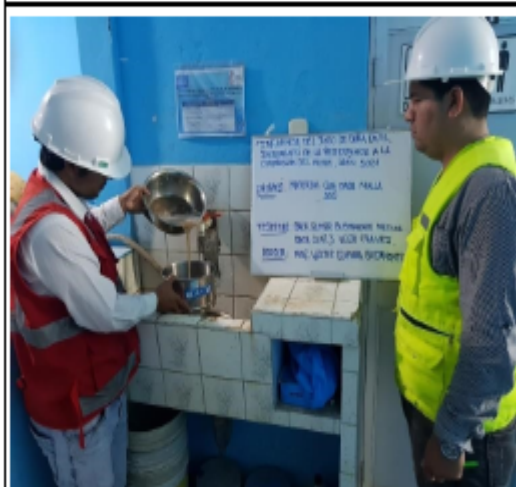
IMAGEN 07. Granulometría por método de lavado.
