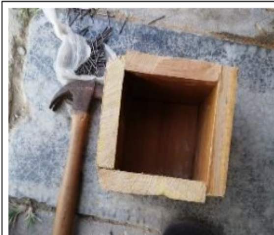
IMAGEN 25. cubos de 0.1 de arista SEGÚN NORMA E.080
