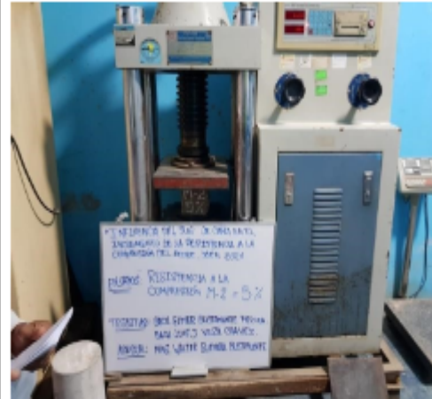
IMAGEN 44. RESISTENCIA A COMPRESION M-2=5%
