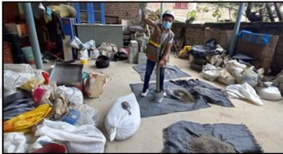
FOTOFOTOGRAFÍA N° 29: Realizando el ensayo de Proctor Modificado proporcionando golpes con el martillo para compactar la muestra.
