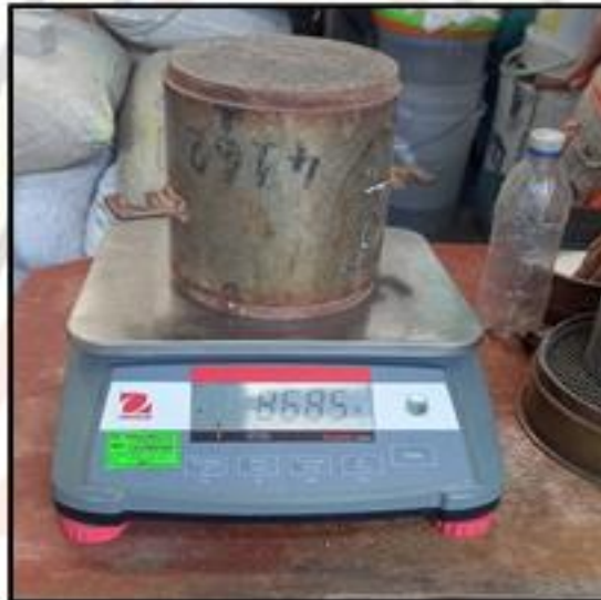
FOTOGRAFÍA N° 33: Realizando el pesado de la muestra compactada más el molde.
