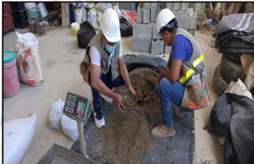
FOTOGRAFÍA N° 27: Realizando el tamizado del material de afirmado por la malla 3/4" para luego realizar los ensayos del Proctor Modificado y el CBR.
