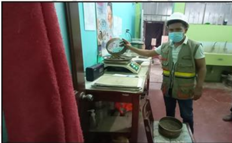
FOTOGRAFÍA N° 15: Realizando el peso correspondiente del material retenido en cada tamiz.
