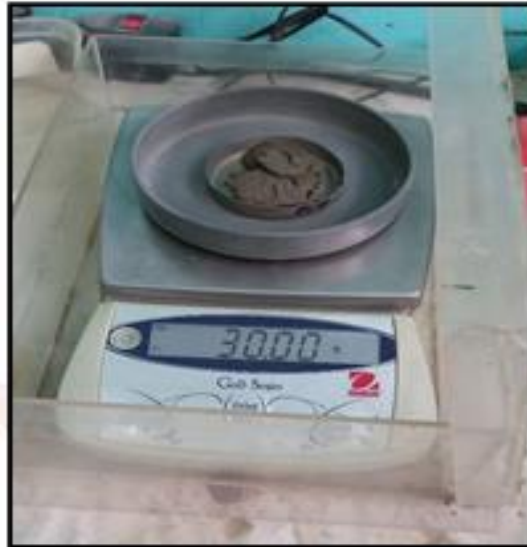
FOTOGRAFÍA N° 24: Realizando el peso de la muestra más la tara en la balanza gramera.
