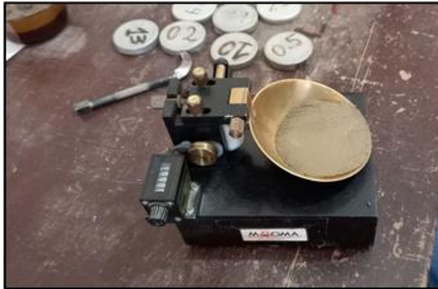
FOTOGRAFIA N° 22: Colocando la muestra húmeda en la Copa de Casagrande para determinación su límite líquido.
