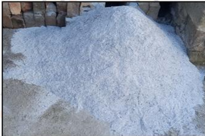
FOTOGRAFIA N° 07: Ceniza de cascara de arroz obtenido después del quemado del ladrillo artesanal.
