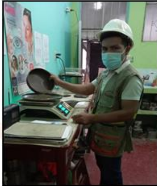
FOTOGRAFÍA N° 16: Realizando el pesado de la muestra más tara en la balanza gramera.
