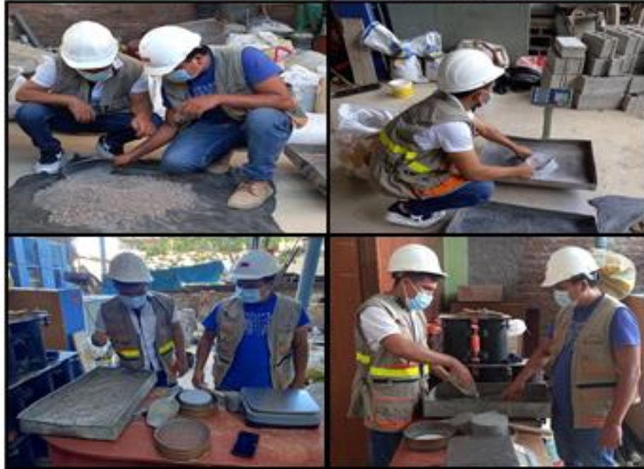
FOTOGRAFÍA N° 28: Material de afirmado tamizado, incorporado ceniza de cascara de arroz con porcentajes de 0%, 2%, 4% y 6% para obtener el contenido óptimo de humedad en el ensayo de Proctor Modificado.
