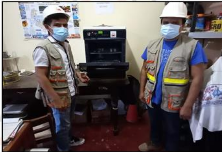
FOTOGRAFÍA N° 11: realizando el respectivo secado de las muestras en el horno.
