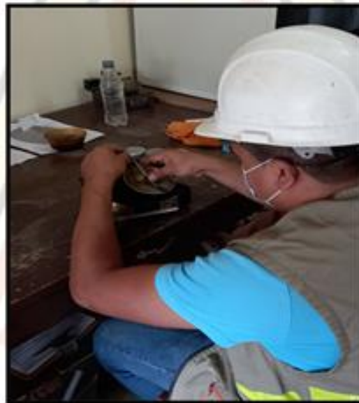
FOTOGRAFIA N° 23: Utilizando el scanalador para dividir la muestra contenida en la Copa de Casagrande.
