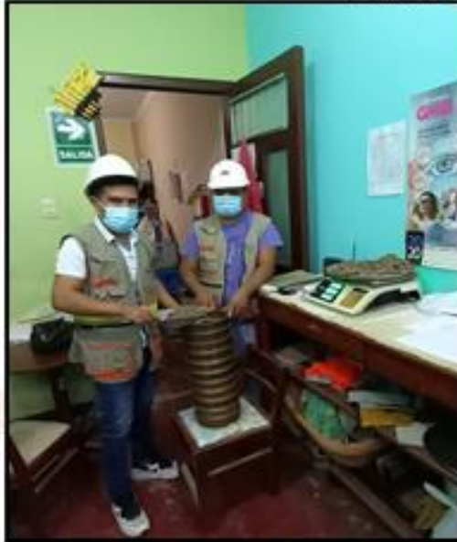
FOTOGRAFÍA N° 14: Realizando el tamizado correspondiente de la muestra para el ensayo granulométrico.
