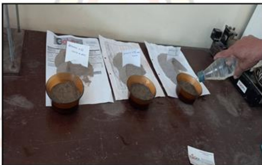
FOTOGRAFÍA N° 21: Incorporación del agua para ensayos de límite líquido y límite plástico con la incorporación del 2%, 4% y 8%.
