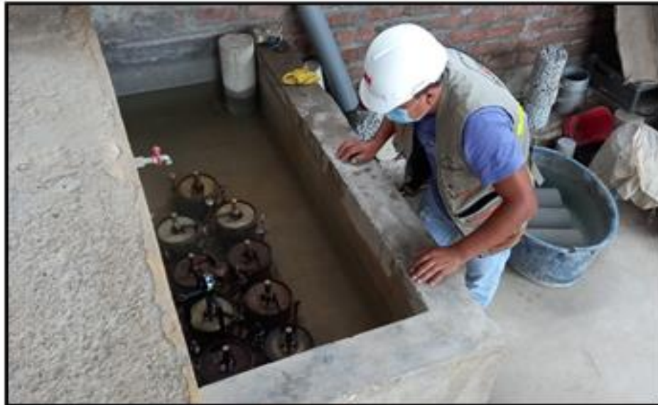
FOTOGRAFIA N° 36: Realizando las lecturas con el Dial para medir el hinchamiento.
