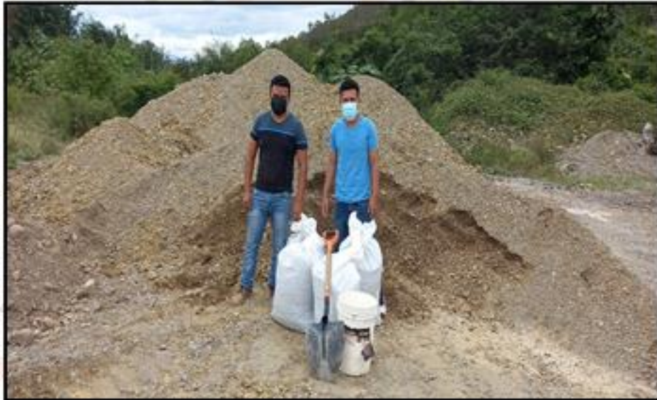
FOTOGRAFÍA N° 09: Extracción de la muestra "material de afirmado".
