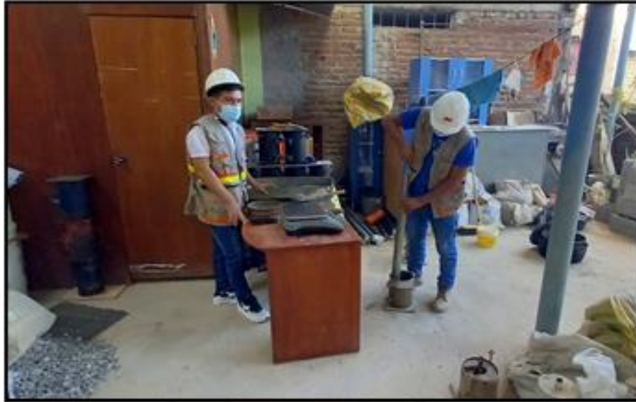
FOTOGRAFÍA N° 32: Realizando el ensayo de CBR proporcionando su número golpes correspondientes con el martillo para compactar la muestra.
