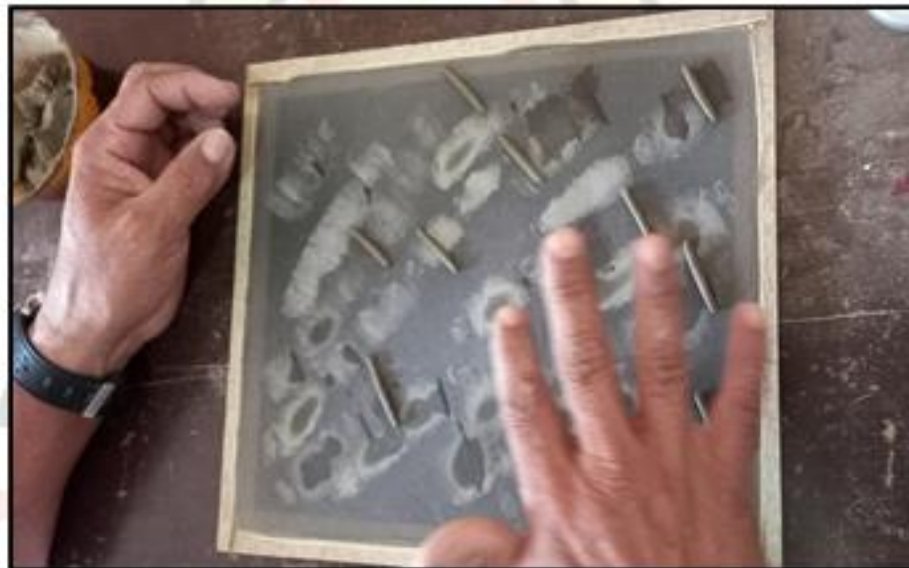
FOTOGRAFÍA N° 25: Realizando el límite plástico con cada una de las muestras del suelo con 0%, 2%, 4% y 6% de ceniza de cascara de arroz.
