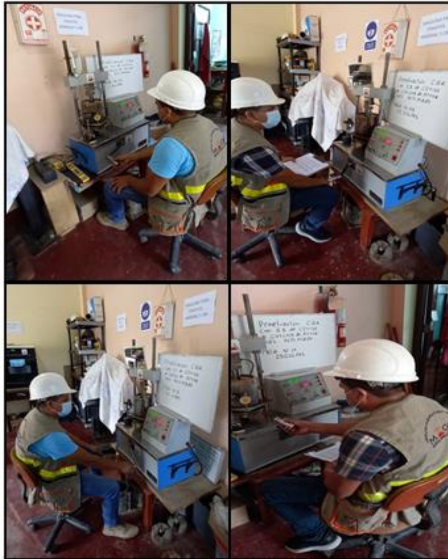
FOTOGRAFIA N° 38: Realizando el ensayo de penetración CBR con las incorporaciones de ceniza de cascara de arroz al 0%, 2%, 4% y 6%.
