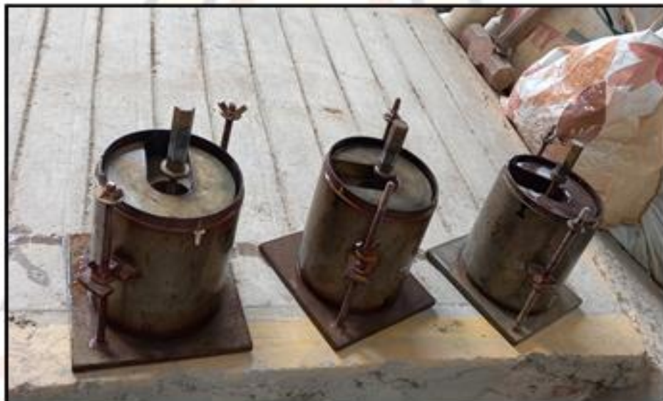
FOTOGRAFIA N° 37: Moldes retirados del tanque de agua, para luego realizar el ensayo de penetración en la prensa de CBR.
