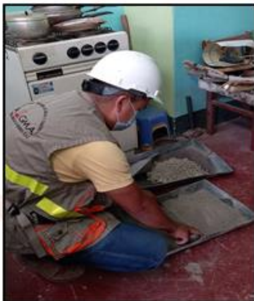
FOTOGRAFÍA N° 18: Realizando la trituración de la muestra.
