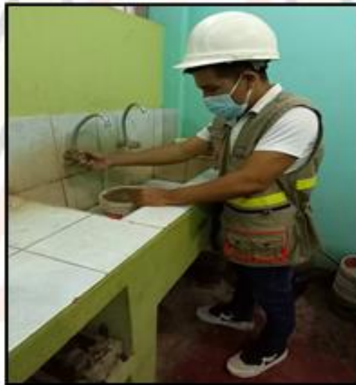
FOTOGRAFÍA N° 17: Realizando el Lavado de la muestra pasado en la malla N° 200.
