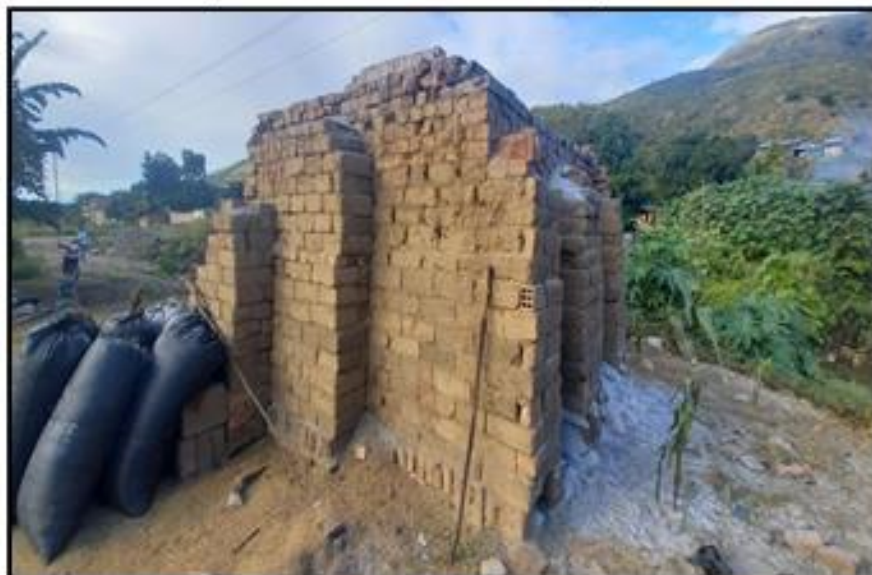
FOTOGRAFIA N° 06: Apreciación del horno donde se realiza el quemado del ladrillo artesanal con cascara de arroz de donde obtiene la ceniza.
