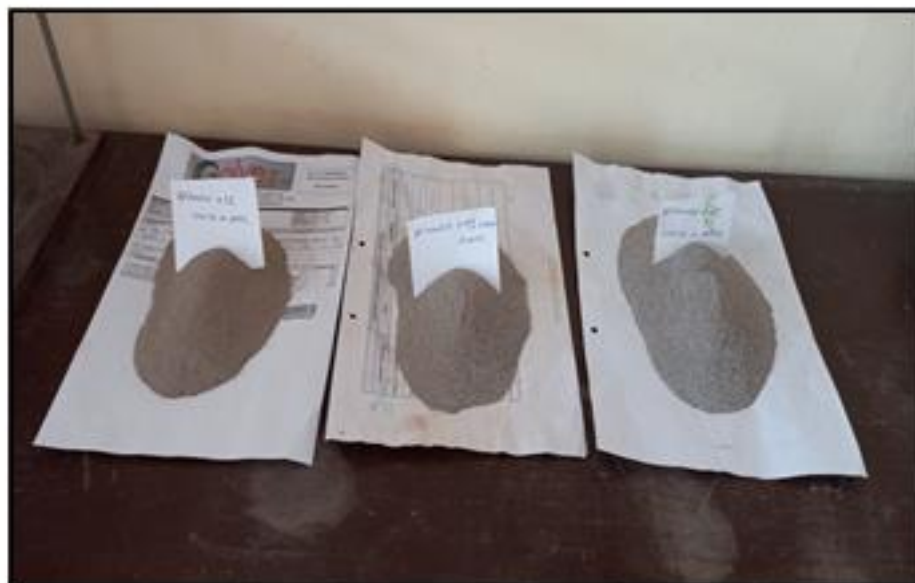
FOTOGRAFÍA N° 20: Material del suelo más la ceniza de cascara de arroz con el 2%, 4% y 8%. Para los ensayos de límite líquido y límite plástico.
