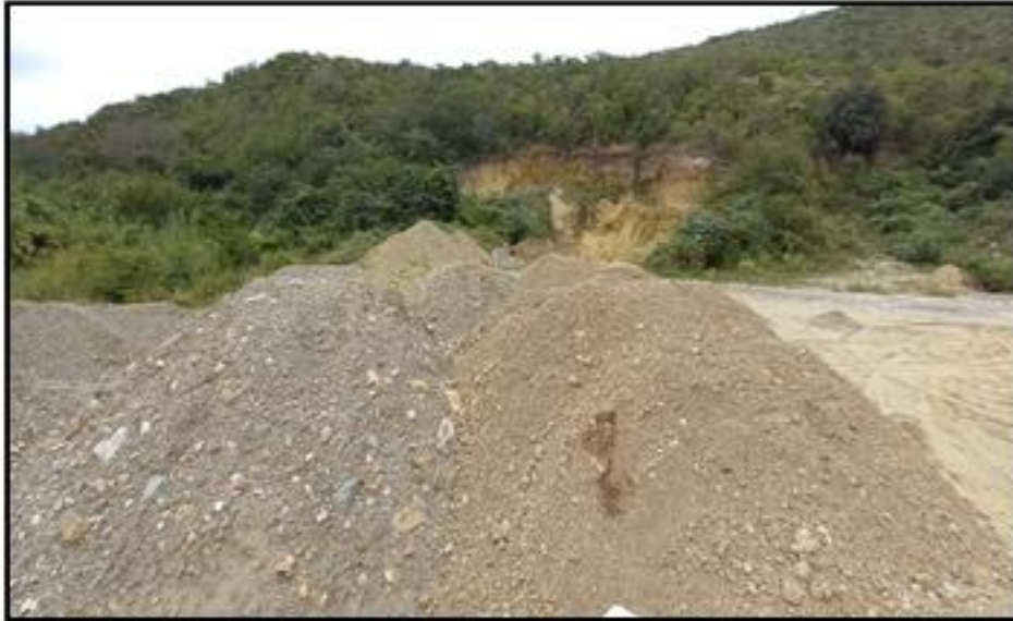
FOTOGRAFÍA N° 08: Apreciación del acopio de afirmado en la Cantera Olano.
