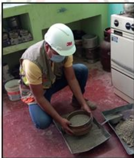
FOTOGRAFÍA N° 19: Realizando el tamizado del suelo en la malla N° 200.
