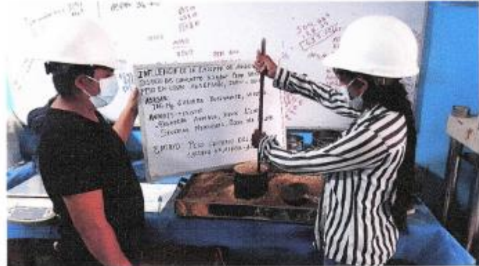
FOTOGRAFIA 19: Muestra la ejecución del Ensayo de Peso Unitario Suelto y Compactado Seco de la Cascara de Arroz. Para el proyecto de Tesis: "Influencia de la cáscara de arroz en el Diseño de Concreto de f'c=210 kg/cm 2 Para Reducir Peso en Losas Aligeradas, Jaén – 2021"
