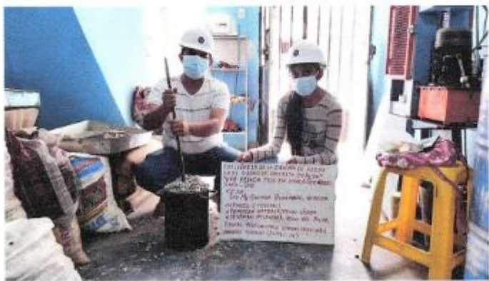
FOTOGRAFIA 14: Muestra la ejecución del Ensayo de Peso Unitario Compactado Seco del Agregado Grueso, bajo la Norma ASTM C 29. Para el proyecto de Tesis: "Influencia de la cáscara de arroz en el Diseño de Concreto f'c=210 \text{ kg/cm}^2 Para Reducir Peso en Losas Aligeradas, Jaén – 2021"
