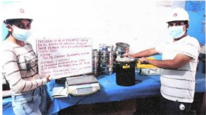
FOTOGRAFIA 13: Muestra la ejecución del Ensayo de Peso Unitario Suelto Seco del Agregado Grueso, bajo la Norma ASTM C 29. Para el proyecto de Tesis: "Influencia de la cáscara de arroz en el Diseño de Concreto de f'c=210 \text{ kg/cm}^2 Para Reducir Peso en Losas Aligeradas, Jaén – 2021"
