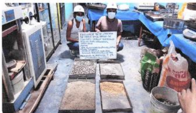
FOTOGRAFIA 21: Muestra la Proporción en Peso de los Agregados y Adición (Cascara de Arroz al 1%) a Utilizar en la Elaboración de los Especímenes de Concreto del proyecto de tesis: "Influencia de la cáscara de arroz en el Diseño de Concreto de f'c=210 kg/cm 2 Para Reducir Peso en Losas Aligeradas, Jaén – 2021"
