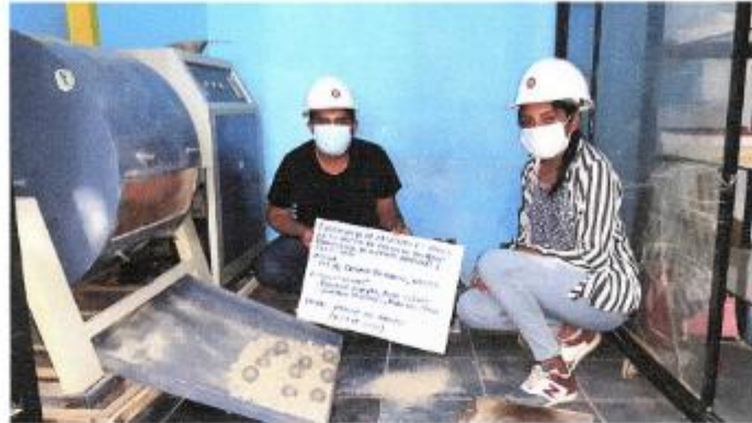
FOTOGRAFIA 07: Muestra la ejecución del Ensayo de Abrasión los Ángeles del agregado Grueso, bajo la Norma ASTM., C 131. Para el proyecto de Tesis: "Influencia de la cáscara de arroz en el Diseño de Concreto de f'c=210 kg/cm 2 Para Reducir Peso en Losas Aligeradas, Jaén - 2021"
