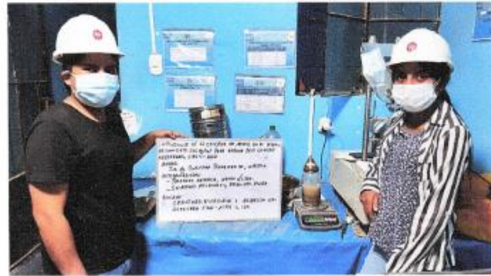
FOTOGRAFIA 12: Muestra la ejecución del Ensayo de Gravedad Específica y Absorción del Agregado Fino, bajo la Norma ASTM C 128. Para el proyecto de Tesis: "Influencia de la cáscara de arroz en el Diseño de Concreto de f'c=210 kg/cm 2 Para Reducir Peso en Losas Aligeradas, Jaén – 2021"
