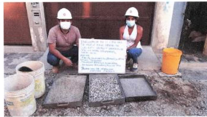
FOTOGRAFIA 20: Muestra la Proporción en Peso de los Agregados a Utilizar en la Elaboración de los Especímenes de Concreto Patrón del proyecto de tesis: "Influencia de la cáscara de arroz en el Diseño de Concreto de f'c=210 kg/cm 2 Para Reducir Peso en Losas Aligeradas, Jaén – 2021"
