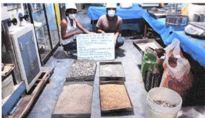
FOTOGRAFIA 22: Muestra la Proporción en Peso de los Agregados y Adición (Cascara de Arroz al 3%) a Utilizar en la Elaboración de los Especímenes de Concreto del proyecto de tesis: "Influencia de la cáscara de arroz en el Diseño de Concreto de f'c=210 kg/cm 2 Para Reducir Peso en Losas Aligeradas, Jaén – 2021"
