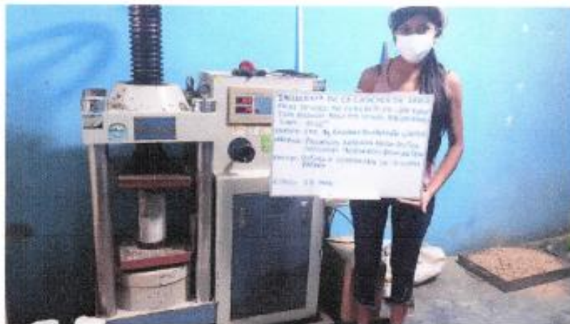
FOTOGRAFIA 30: Muestra la Rotura a Compresión de Especímenes de Concreto (ASTM C-39) a 28 días Proyecto de Tesis: "Influencia de la cáscara de arroz en el Diseño de Concreto de f'c=210 \text{ kg/cm}^2 Para Reducir Peso en Losas Aligeradas, Jaén - 2021"
