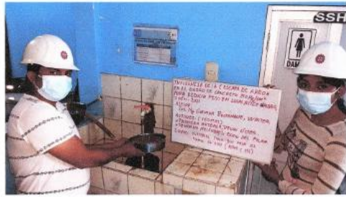
FOTOGRAFIA 06: Muestra la ejecución del Ensayo de Material fino que pasa el Tamiz N° 200 del Agregado Fino, bajo la Norma ASTM., C 117. Para el proyecto de Tesis: "Influencia de la cáscara de arroz en el Diseño de Concreto de f'c=210 kg/cm 2 Para Reducir Peso en Losas Aligeradas, Jaén - 2021"
