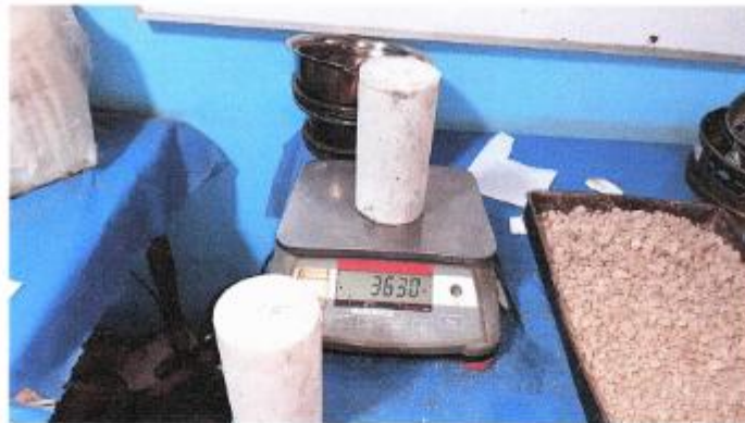
FOTOGRAFIA 27: Muestra el proceso del peso unitario seco del concreto endurecido del Proyecto de Tesis: "Influencia de la cáscara de arroz en el Diseño de Concreto de f'c=210 kg/cm 2 Para Reducir Peso en Losas Aligeradas, Jaén – 2021"
