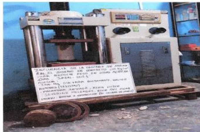
FOTOGRAFIA 28: Muestra la Rotura a Compresión de Especímenes de Concreto (ASTM C-39) a 7 días Proyecto de Tesis: "Influencia de la cáscara de arroz en el Diseño de Concreto de f'c=210 kg/cm 2 Para Reducir Peso en Losas Aligeradas, Jaén – 2021"
