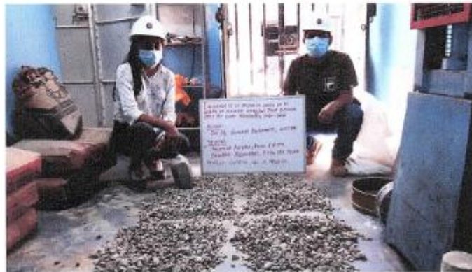
FOTOGRAFIA 02: Muestra el proceso de cuarteo del agregado grueso (piedra chancada) proveniente de la cantera Olano, para tomar posteriormente muestras homogéneas y representativas del agregado para el proyecto de tesis: "Influencia de la cáscara de arroz en el Diseño de Concreto de f'c=210 kg/cm 2 Para Reducir Peso en Losas Aligeradas, Jaén – 2021"
