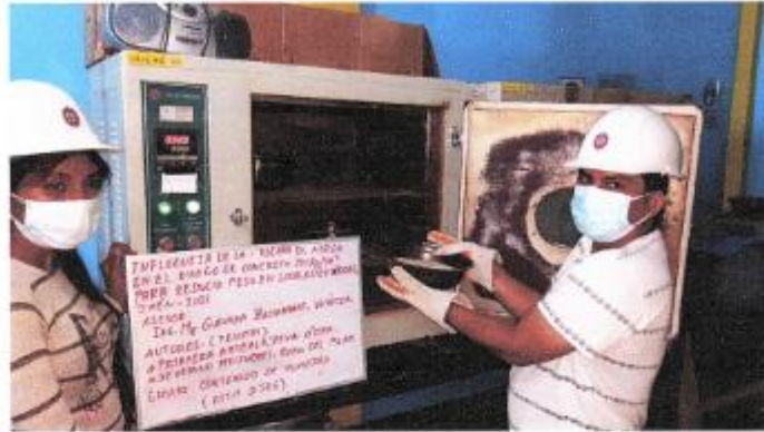
FOTOGRAFIA 03: Muestra la ejecución del Ensayo de Contenido de Humedad del Agregado Fino, bajo la Norma ASTM., D 566. Para el proyecto de Tesis: "Influencia de la cáscara de arroz en el Diseño de Concreto de f'c=210 kg/cm 2 Para Reducir Peso en Losas Aligeradas, Jaén – 2021"
