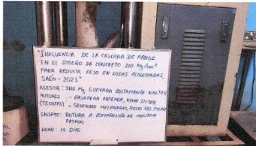
FOTOGRAFIA 29: Muestra la Rotura a Compresión de Especímenes de Concreto (ASTM C-39) a 14 días Proyecto de Tesis: "Influencia de la cáscara de arroz en el Diseño de Concreto de f'c=210 \text{ kg/cm}^2 Para Reducir Peso en Losas Aligeradas, Jaén - 2021"
