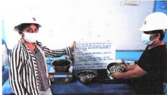
FOTOGRAFIA 09: Muestra la ejecución del Ensayo de Análisis Granulométrico de agregado Grueso por Tamizado, bajo la Norma ASTM., C 136. Para el proyecto de Tesis: "Influencia de la cáscara de arroz en el Diseño de Concreto de f'c=210 kg/cm 2 Para Reducir Peso en Losas Aligeradas, Jaén – 2021"
