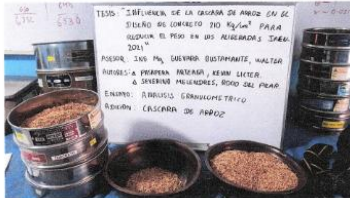
FOTOGRAFIA 17: Muestra la ejecución del Ensayo de Análisis Granulométrico por Tamizado de la Cáscara de Arroz. Para el proyecto de Tesis: "Influencia de la cáscara de arroz en el Diseño de Concreto de f'c=210 \text{ kg/cm}^2 Para Reducir Peso en Losas Aligeradas, Jaén – 2021"
