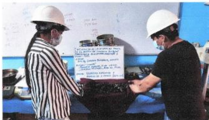
FOTOGRAFIA 10: Muestra la ejecución del Ensayo de Absorción del agregado grueso, bajo la Norma ASTM C 127. Para el proyecto de Tesis: "Influencia de la cáscara de arroz en el Diseño de Concreto f'c=210 kg/cm 2 Para Reducir Peso en Losas Aligeradas, Jaén – 2021"
