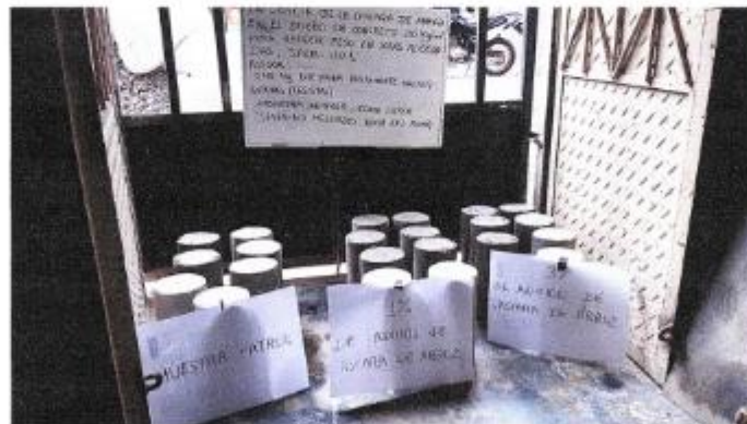
FOTOGRAFIA 26: Muestra los Especímenes de Concreto desmoldados y con su respectiva identificación del Proyecto de Tesis: "Influencia de la cáscara de arroz en el Diseño de Concreto de f'c=210 \text{ kg/cm}^2 Para Reducir Peso en Losas Aligeradas, Jaén - 2021"
