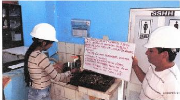
FOTOGRAFIA 05: Muestra la ejecución del Ensayo de Material fino que pasa el Tamiz N° 200 del Agregado Grueso, bajo la Norma ASTM., C 117. Para el proyecto de Tesis: "Influencia de la cáscara de arroz en el Diseño de Concreto de f'c=210 kg/cm 2 Para Reducir Peso en Losas Aligeradas, Jaén - 2021"
