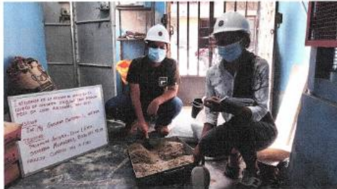
FOTOGRAFIA 01: Muestra el proceso de cuarteo del agregado fino (arena procesada) proveniente de la cantera Olano, para tomar posteriormente muestras homogéneas y representativas del agregado para el proyecto de tesis: "Influencia de la cáscara de arroz en el Diseño de Concreto de f'c=210 kg/cm 2 Para Reducir Peso en Losas Aligeradas, Jaén – 2021"
