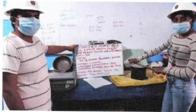
FOTOGRAFIA 15: Muestra la ejecución del Ensayo de Peso Unitario Suelto Seco del Agregado Fino, bajo la Norma ASTM C 29. Para el proyecto de Tesis: "Influencia de la cáscara de arroz en el Diseño de Concreto de f'c=210 kg/cm 2 Para Reducir Peso en Losas Aligeradas, Jaén - 2021"
