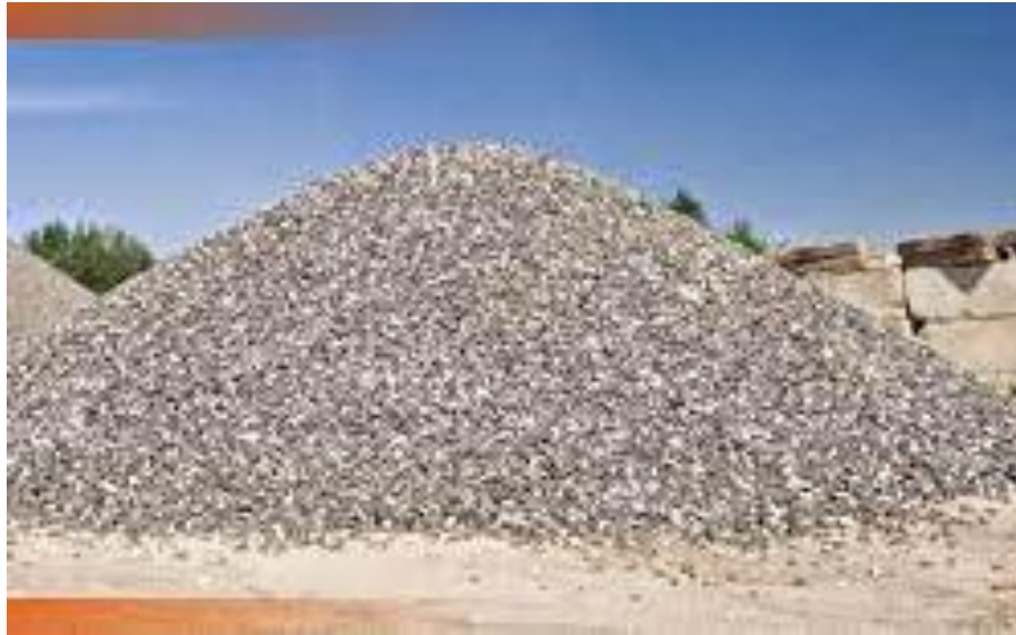
FIGURA N° 5 Agregado Grueso o Piedra
