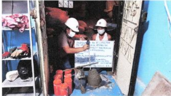
FOTOGRAFIA 23: Muestra la Consistencia Mediante la Prueba de Slump de la Mezcla de Concreto con Adición al 1% del Proyecto de Tesis: "Influencia de la cáscara de arroz en el Diseño de Concreto de f'c=210 kg/cm 2 Para Reducir Peso en Losas Aligeradas, Jaén – 2021"
