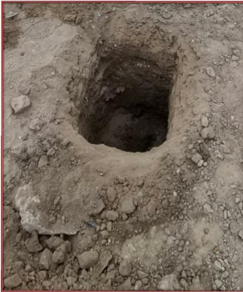
Fotografía N° 07: Perfil de suelo calicata C-02 vista de dos capas (capa 01 material de relleno 0.00m – 0.60m y la capa 02 arena arcillosa de 0.60m – 1.50m).
