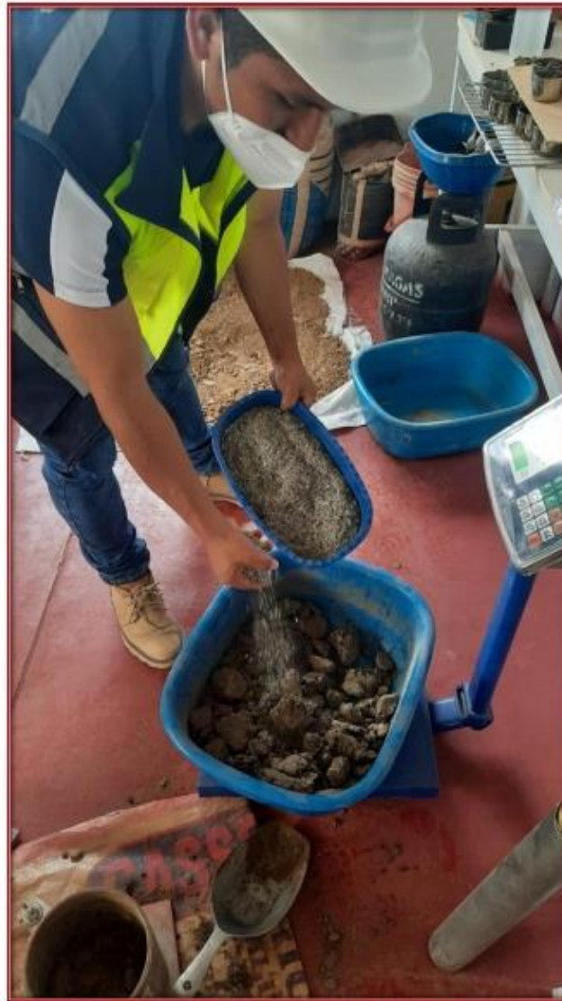
Fotografía N° 40: Adición de polímero PET reciclado molido en porcentajes de 1%, 3%, 5% y 7%.
