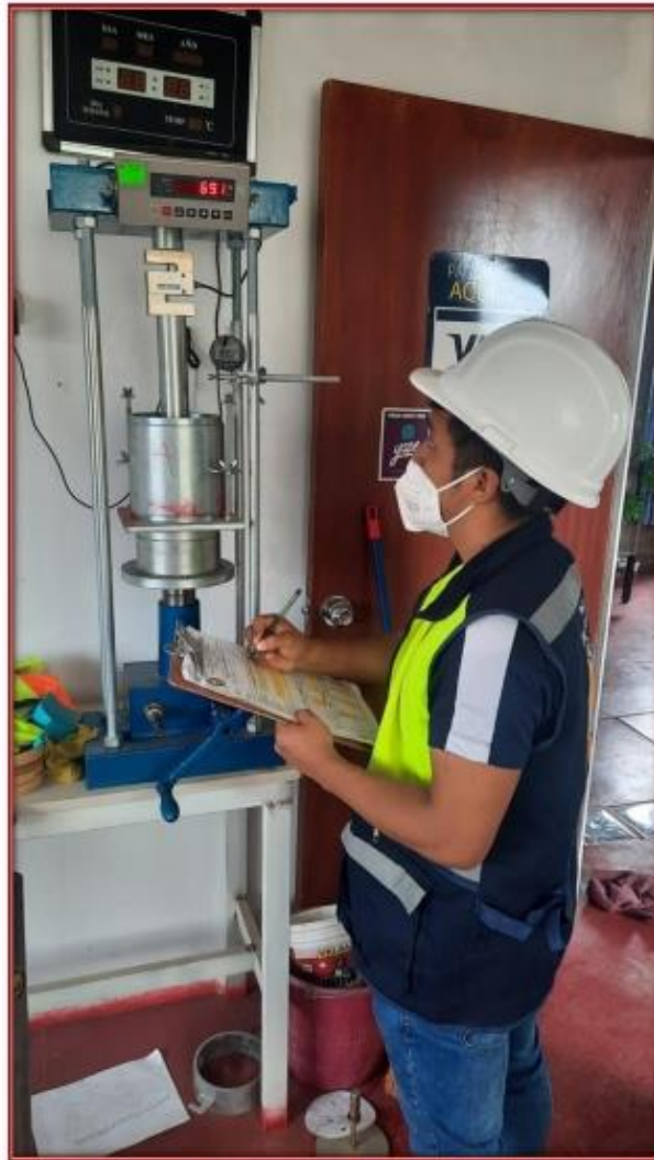
Fotografía N° 41: Tomando medidas diarias del micro comparador durante al menos 4 días
