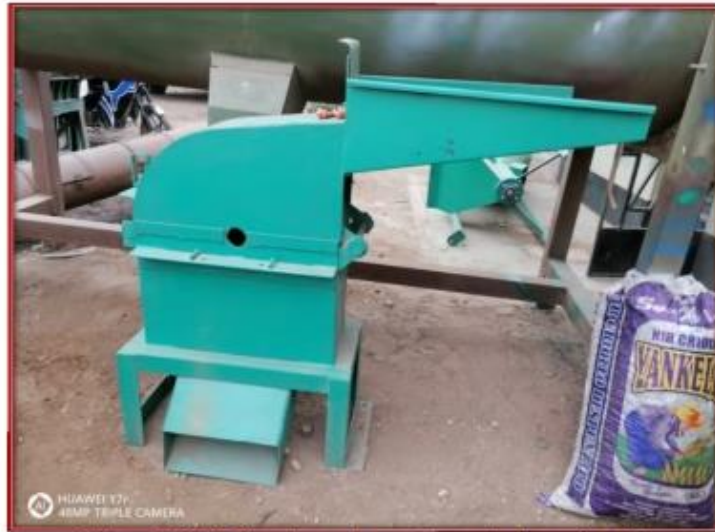
Fotografía N° 12: Maquina usada para triturar el polimero fase 01.
