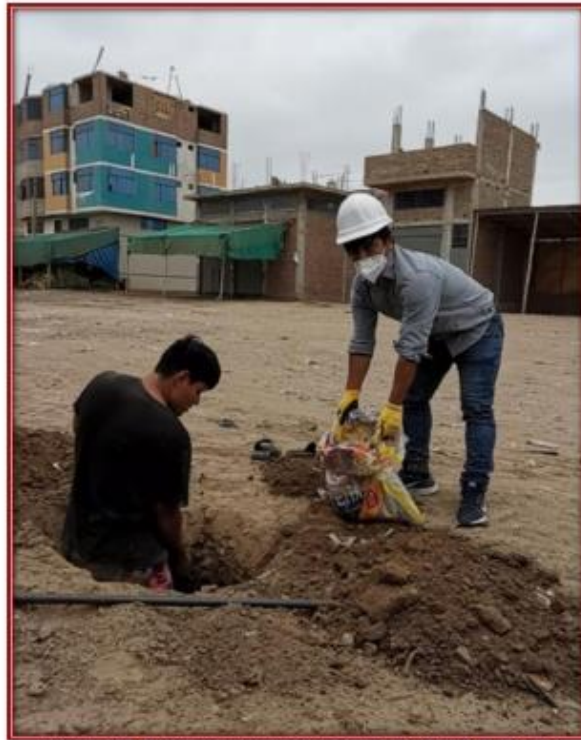
Fotografía N° 09: Toma de muestras de la calicata C-02 en la Av. Venezuela
