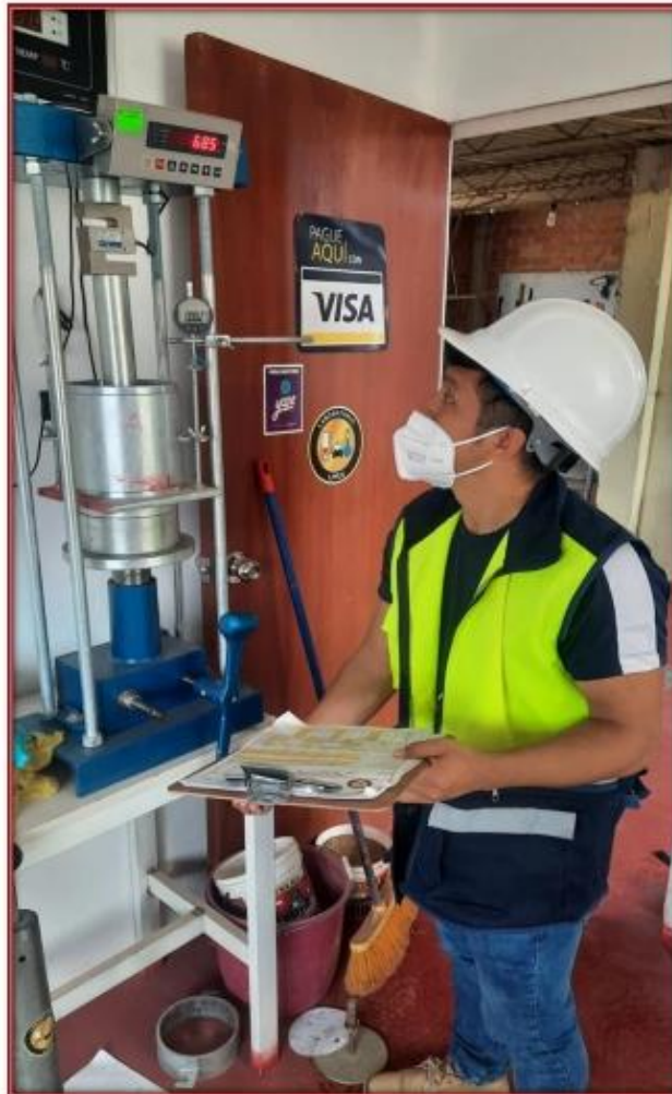
Fotografía N° 42: Aplicando la carga sobre el pistón de penetración mediante la prensa CBR y tomar las lecturas de la curva presión penetración.
