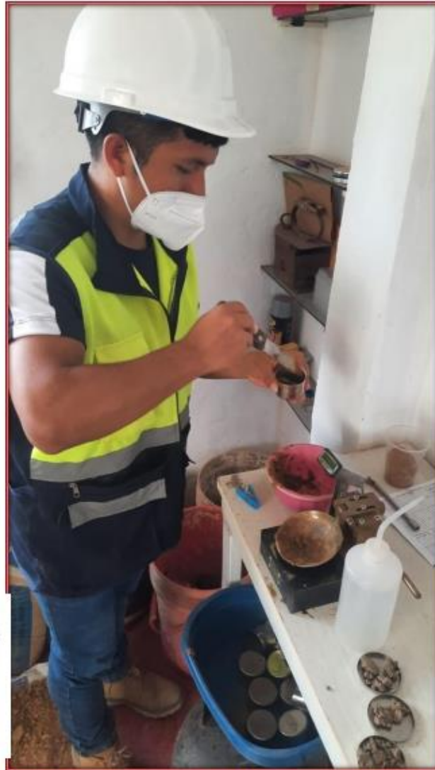
Fotografía N° 28. Proceso de elaboración de los LIMITES ATTERBERG para las muestras de las calicatas C-01 y C-02
