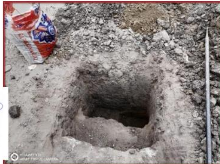
Fotografía N° 04: Perfil de suelo calicata C-01 vista de tres capas (capa 01 material de relleno 0.00m – 0.10m, capa 02 arcilla compacta de 0.10m – 0.90m y la capa 03 arena arcillosa de 0.90m-1.50m).
