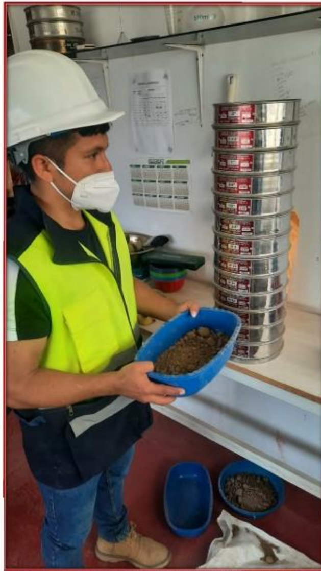
Fotografía N° 32 proceso de tamizado por las distintas mallas en el análisis granulométrico.
