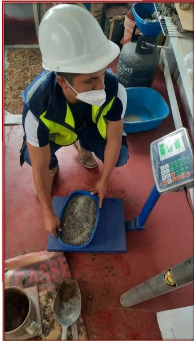
Fotografía N° 39: Pesado del polímero reciclado PET para la adición a la muestra
