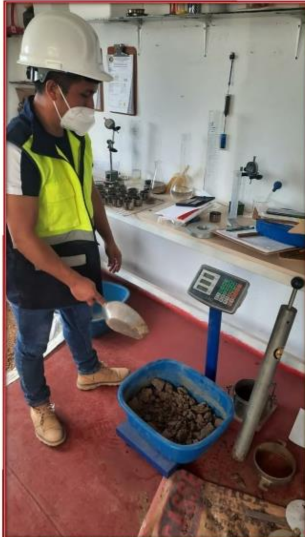
Fotografia N° 34: Pesado de las muestras para realizar el ensayo del proctor modificado y el CBR.
