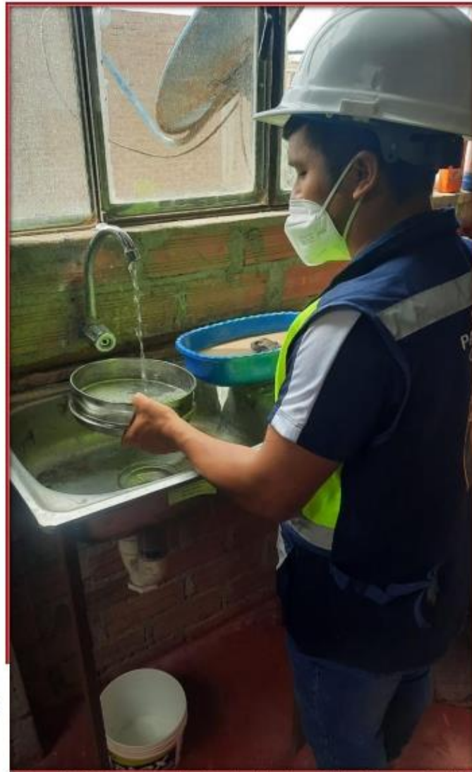
Fotografía N° 31: proceso de determinación de materiales finos en el análisis granulométrico.
