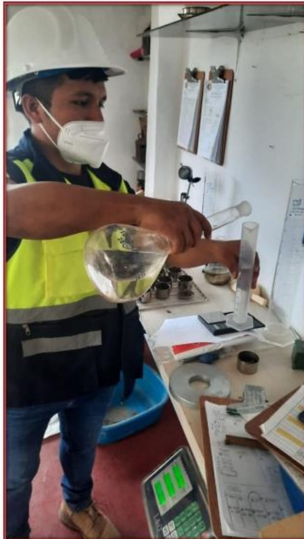
Fotografía N° 30: Adición de agua destilada a las muestras para los ensayos utilizando equipos de precisión.
