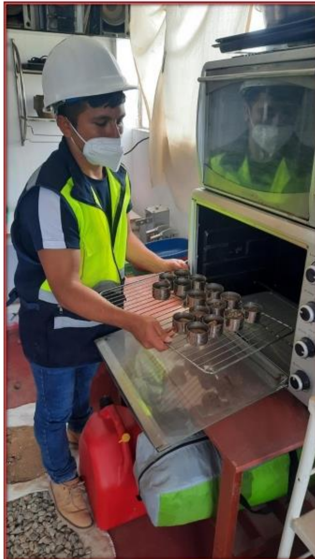
Fotografía N° 27: Muestras ingresadas al horno por 24 horas a una temperatura de 110 °C para determinar las propiedades físicas y mecánicas
