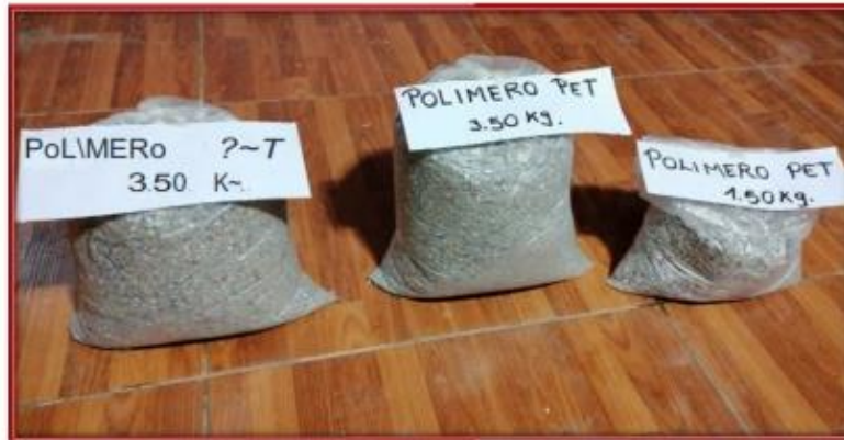
Fotografía N° 16: Muestra de Polímero reciclado PET molido a Utilizar en los ensayos de laboratorio.
