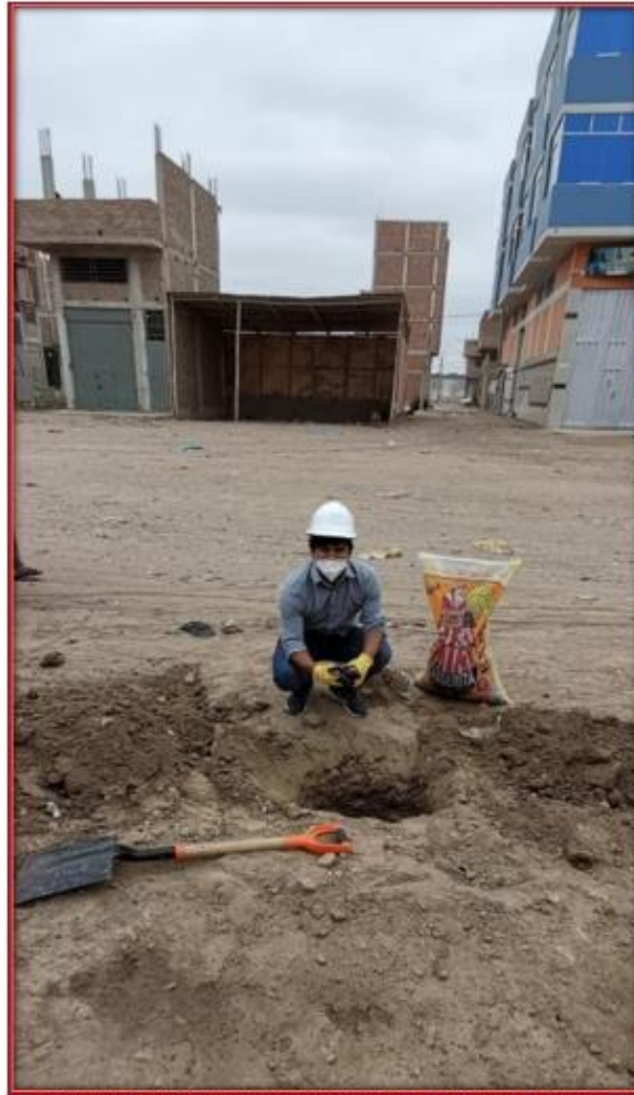
Fotografía N° 09: toma de muestras en la calicata C-02 en la Av. Venezuela
