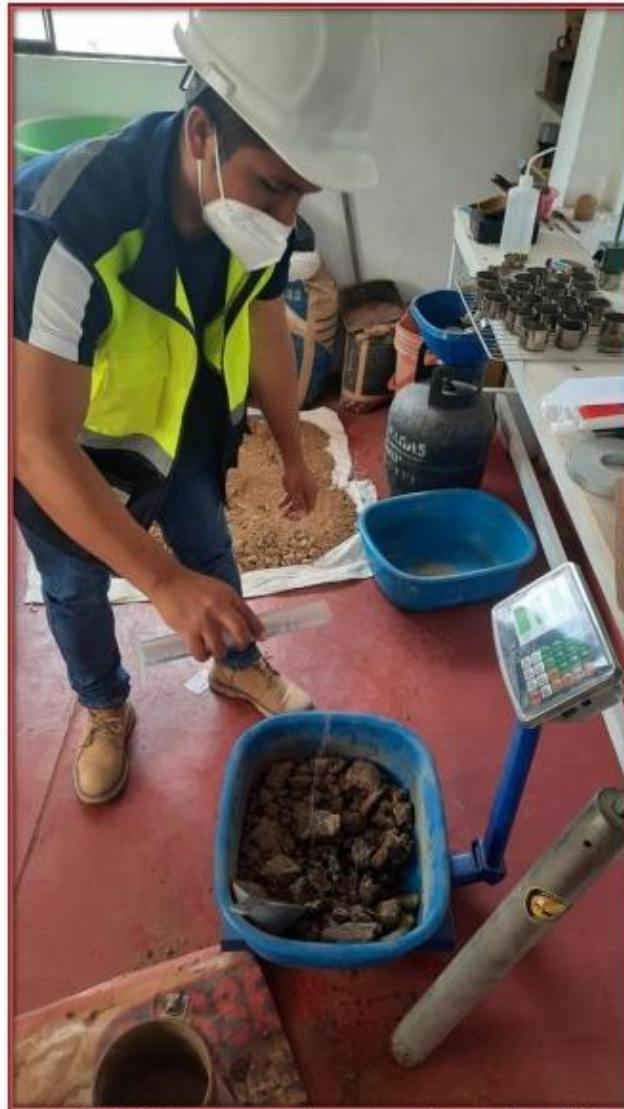
fotografía N° 35: Adicionando agua a la muestra suelo para alcanzar la humedad óptima para el ensayo CBR.
