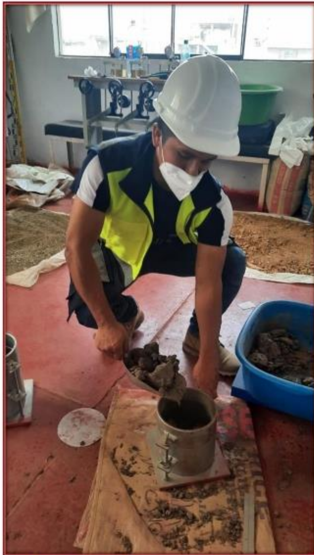
foto N° 36: Rellenando la muestra en tres moldes CBR estandarizados de 15,24 cm de diámetro y 17,78 cm de altura.
