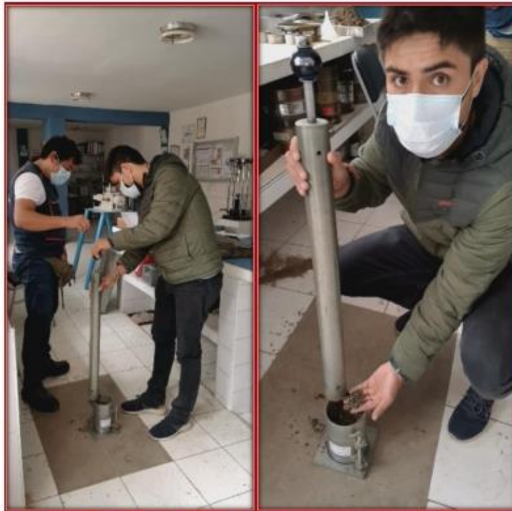
Fotografía N° 19 proceso de elaboración del ensayo de Proctor.
