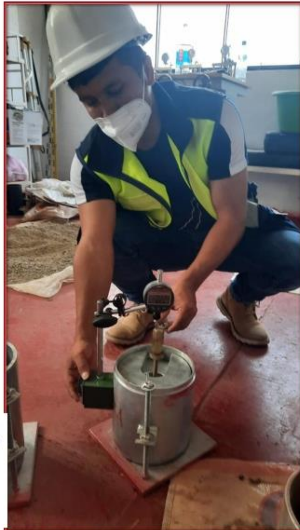
Fotografía N° 38: Colocando el trípode de medida sobre el borde del molde, coincidiendo el vástago del micro comparador
