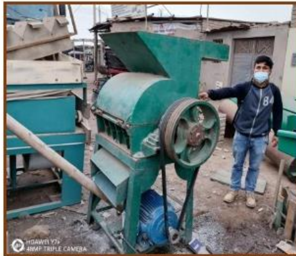
Fotografía N° 14: Molino Usado para moler el polímero reciclado PET (Motor de 20hp, producción 300kg/hora)
