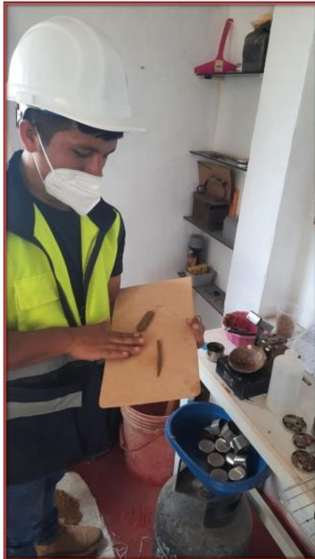
Fotografía N° 29. Determinación los límites plásticos de las muestras por el Método de los Rollos.
