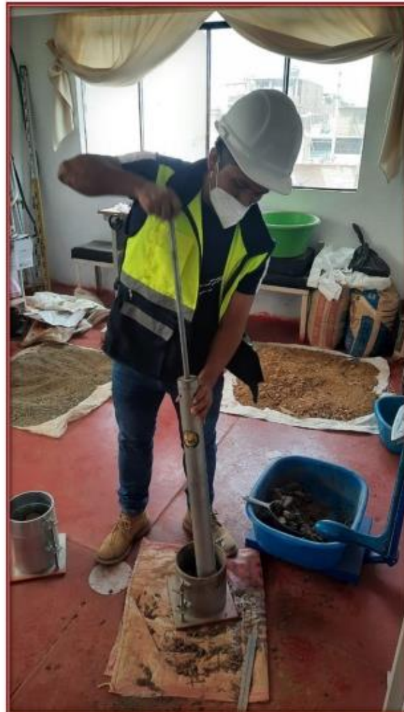
Fotografía N° 37. Compactando la muestra en 3 capas por molde siendo la energía de compactación de cada molde de 15, 30 o 60 golpes por capa mediante una maza de 2,5 kg que se deja caer libremente desde una altura de 305 mm
