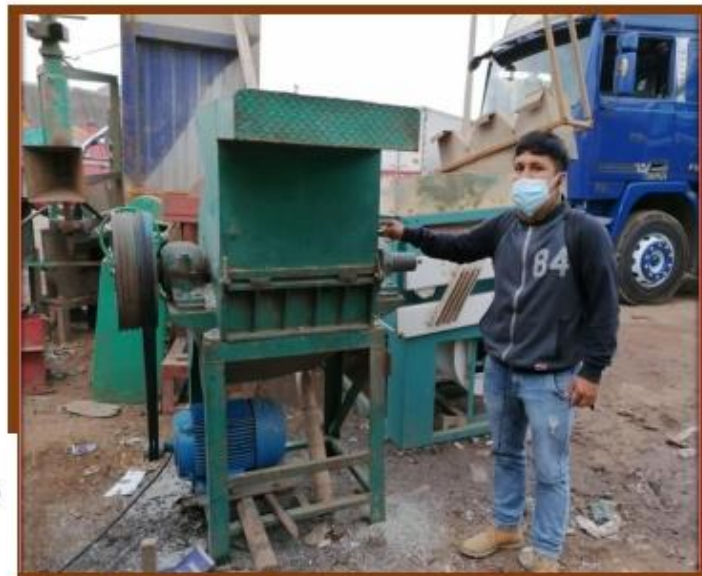
Fotografía N° 15: Molino Usado para moler el polímero reciclado PET (Motor de 20hp, producción 300kg/hora)
