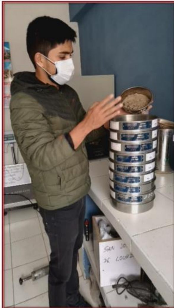
Fotografia N° 20: tamizado de la muestra para hallar su granulometria.
