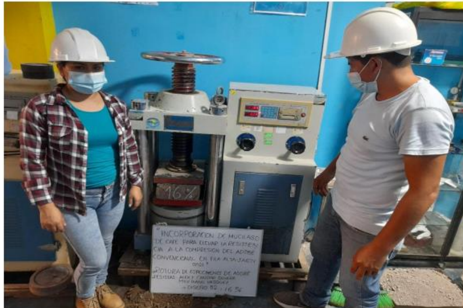
FOTOGRAFÍA 15: Muestras de ensayo a la resistencia a la compresión de adobe con adición de mucílago de café al 16%.
