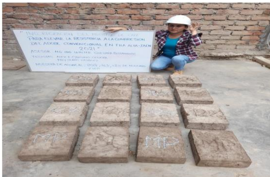
FOTOGRAFÍA 14: Muestras de adobes al 12%, 16%, 20% y más la muestra patrón 0% a los 28 días de secado.
