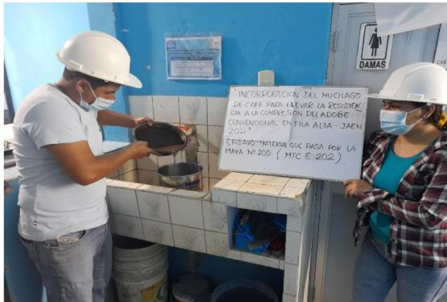
FOTOGRAFÍA 03: Ensayo del material que pasa por la malla N°200.
