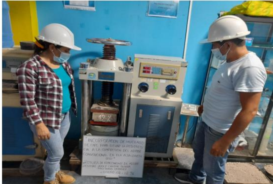
FOTOGRAFÍA 15: Muestras de ensayo de resistencia a la compresión de adobe con adición de mucilago de café al 12%.
