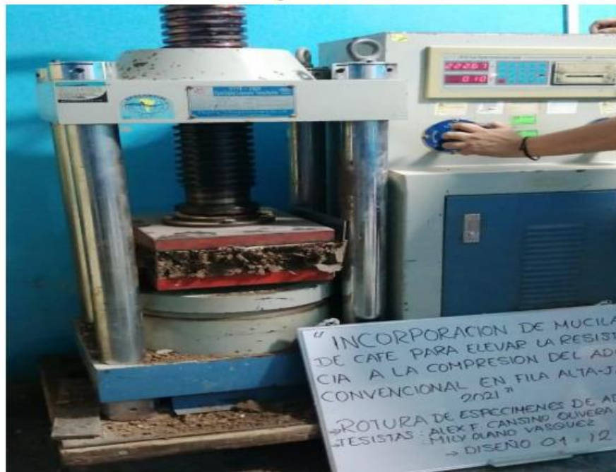
TOGRAFÍA 15: Rotura de la muestra de adobe con adición de mucilago de café al 12%.
