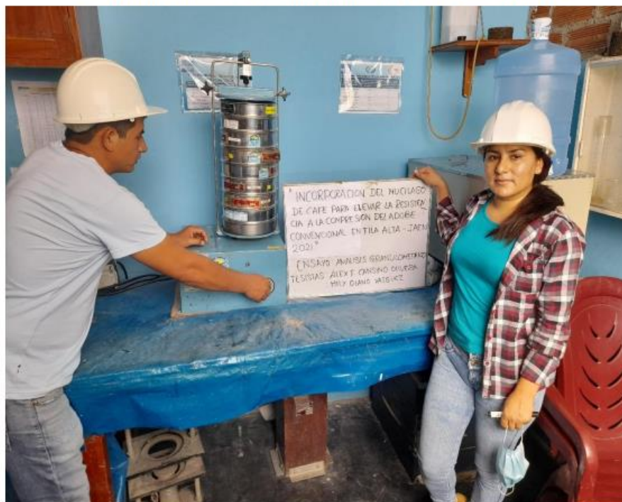
FOTOGRAFÍA 04: Ensayo de análisis de granulometría por tamizado.
