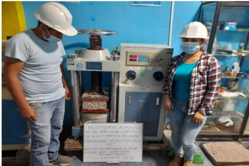
FOTOGRAFÍA 15: Muestras de ensayo a la resistencia a la compresión de adobe con adición de mucílago de café al 20%.
