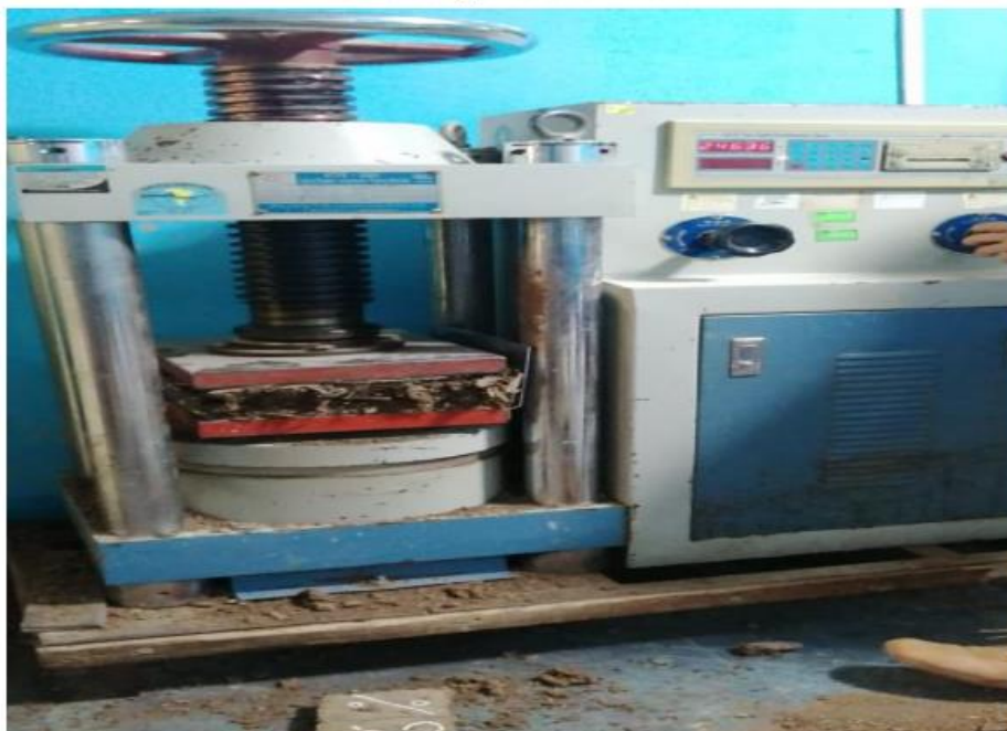
FOTOGRAFÍA 15: Rotura de la muestra de adobe con adición de mucílago de café al 16%.
