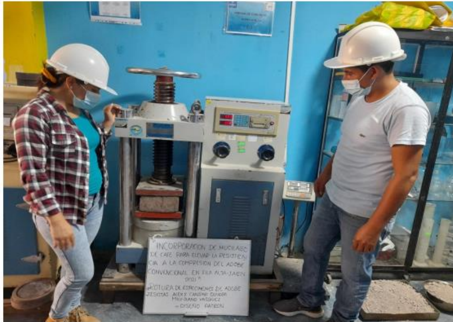
FOTOGRAFÍA 14: Muestras de ensayo de resistencia a la compresión de la muestra patrón.
