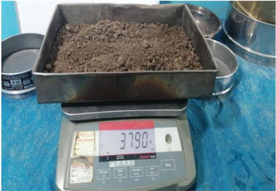
FOTOGRAFÍA 02: Pesado de muestra representativa después del cuarteo.
