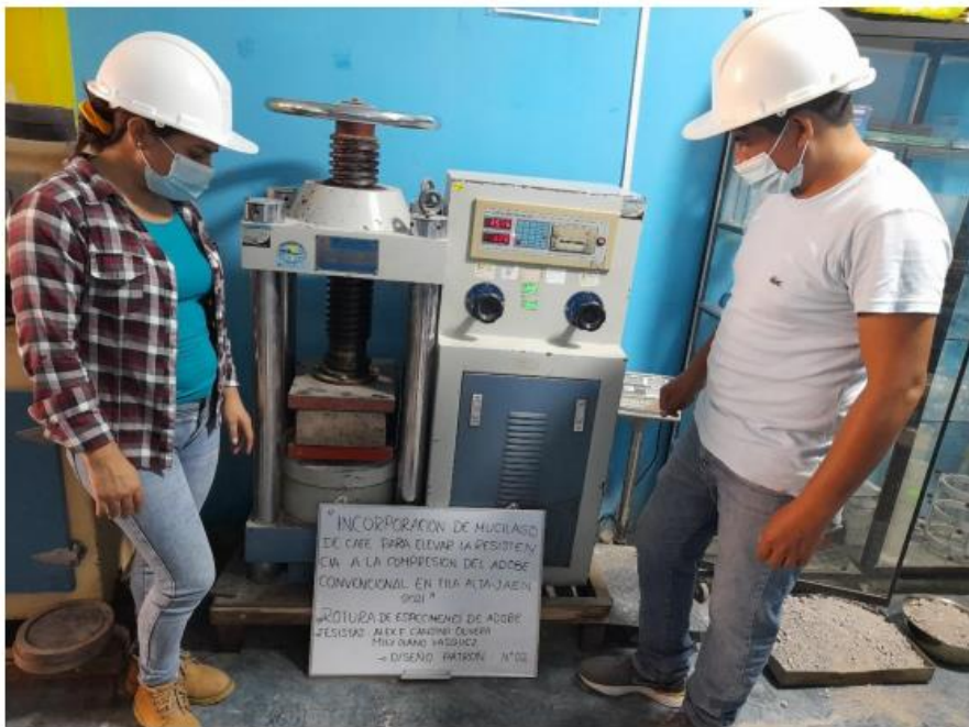
FOTOGRAFÍA 14: Rotura del adobe muestra patrón.
