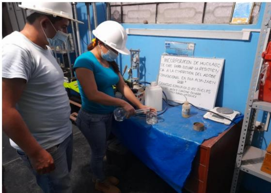
FOTOGRAFÍA 06: Ensayo de peso Específico del suelo.
