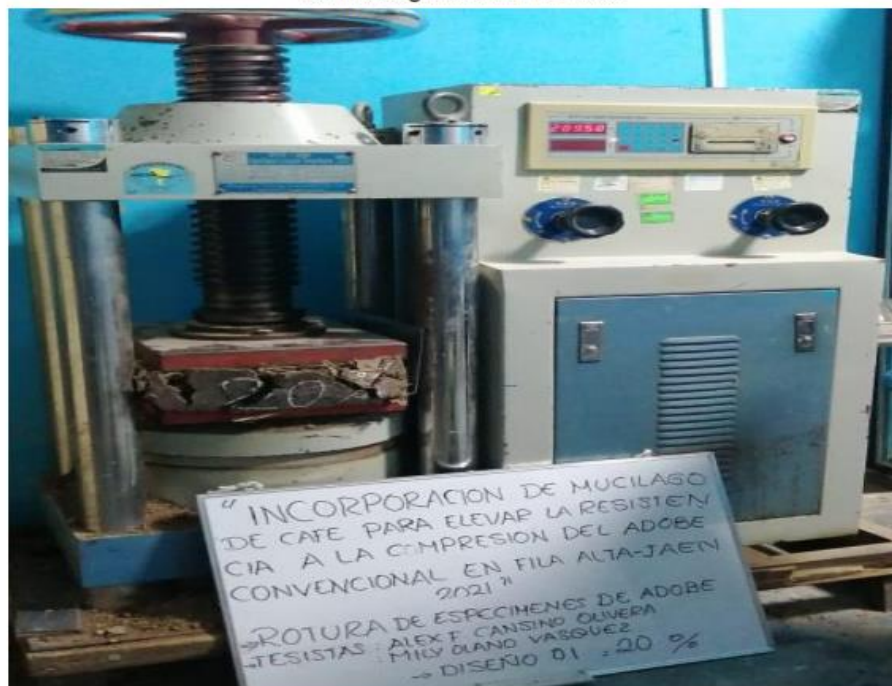
FOTOGRAFÍA 15: Rotura de la muestra de adobe con adición de mucílago de café al 20%.
