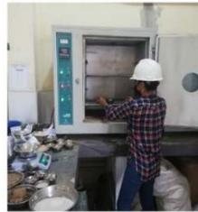
Ensayo de contenido de humedad a los agregados.
