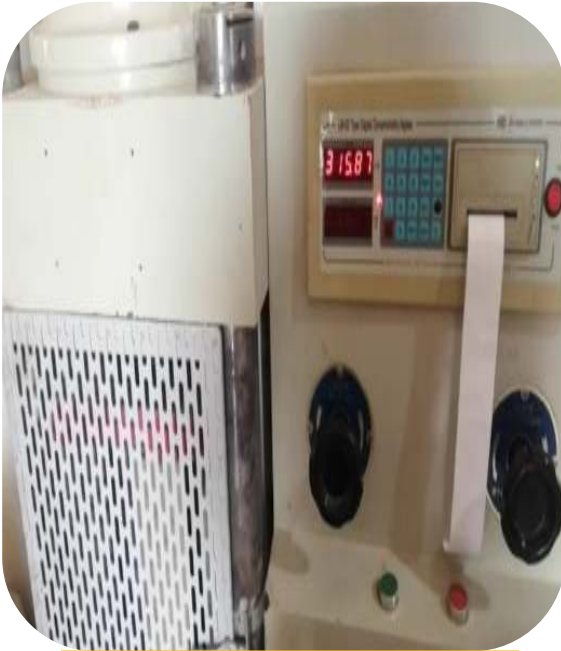
Fotografía 53. Lectura de probeta a los 28 días del concreto convencional
