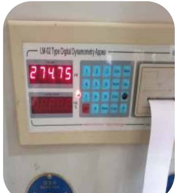
Fotografía 52. Lectura de probeta a los 14 días del concreto convencional
