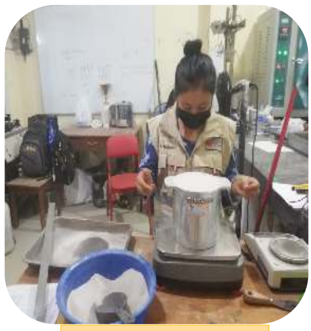
Fotografía 36. Peso del material compactado
