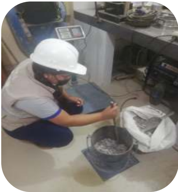
Fotografía 33. Vibración por capa con 25 golpes
