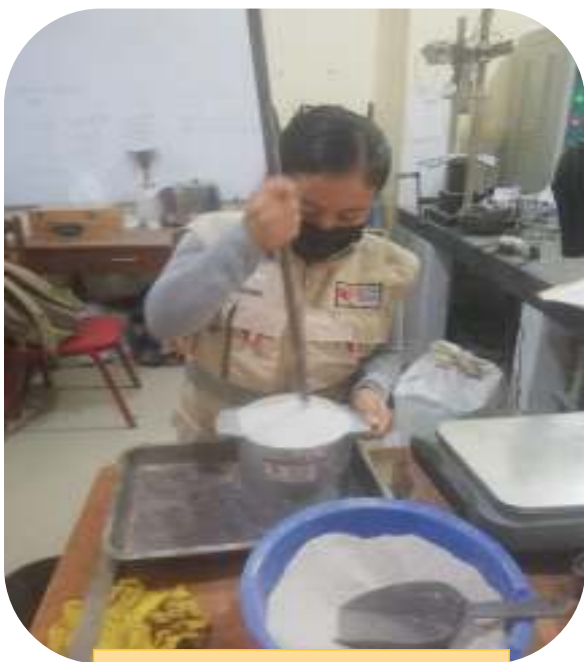
Fotografía 35. Vibración por capa con 25 golpes
