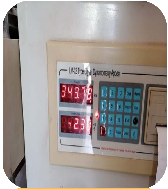
Fotografía 54. Lectura de probeta a los 28 días con 1% de fibra de agave lechuguilla
