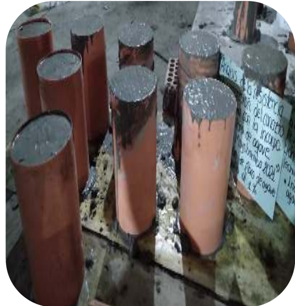
Fotografía 38. Colocación de la mezcla de concreto 175 kg/cm 2 a los moldes
