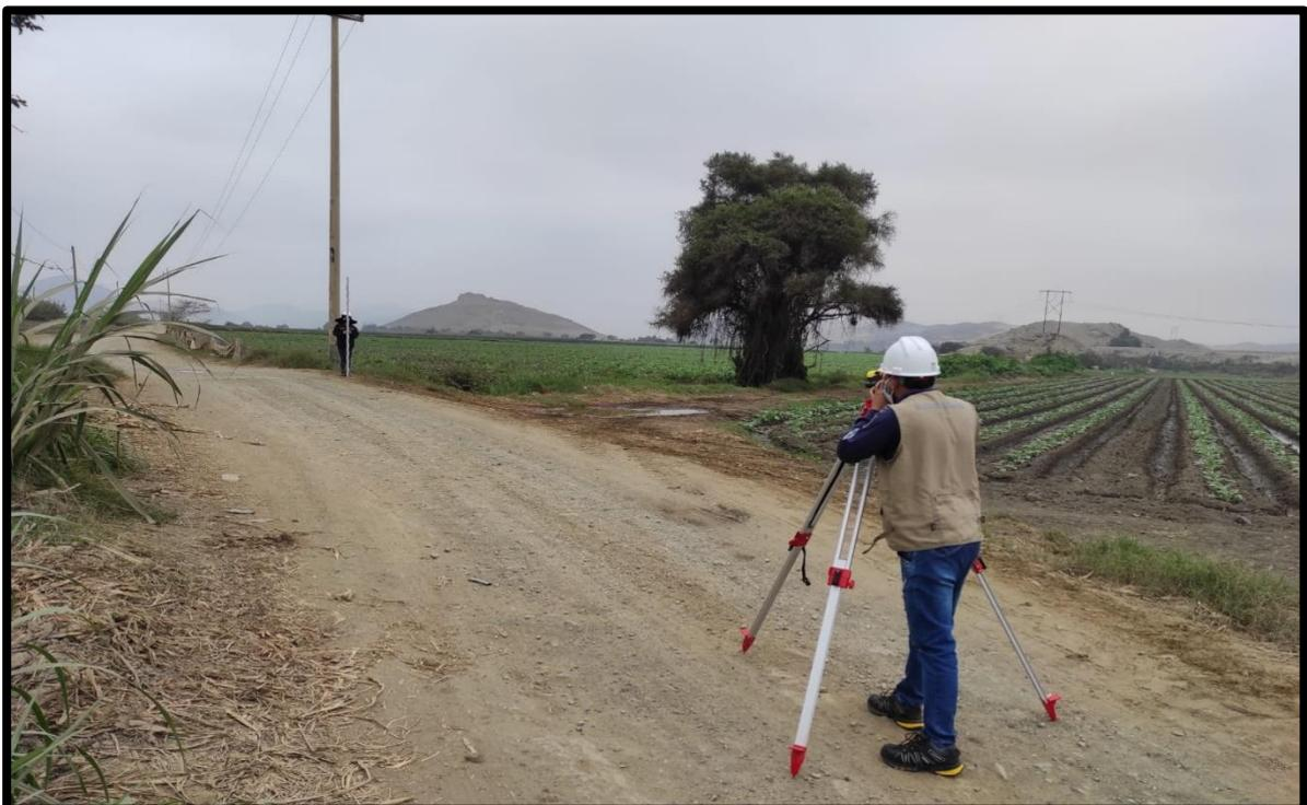
FIGURA N°10: SE OBSERVA EL LEVANTAMIENTO DE LA VIA CON LA ESTACION, NIVEL Y MIRA EN EL KM 15 CASCAJAL – IZQUIERDO
