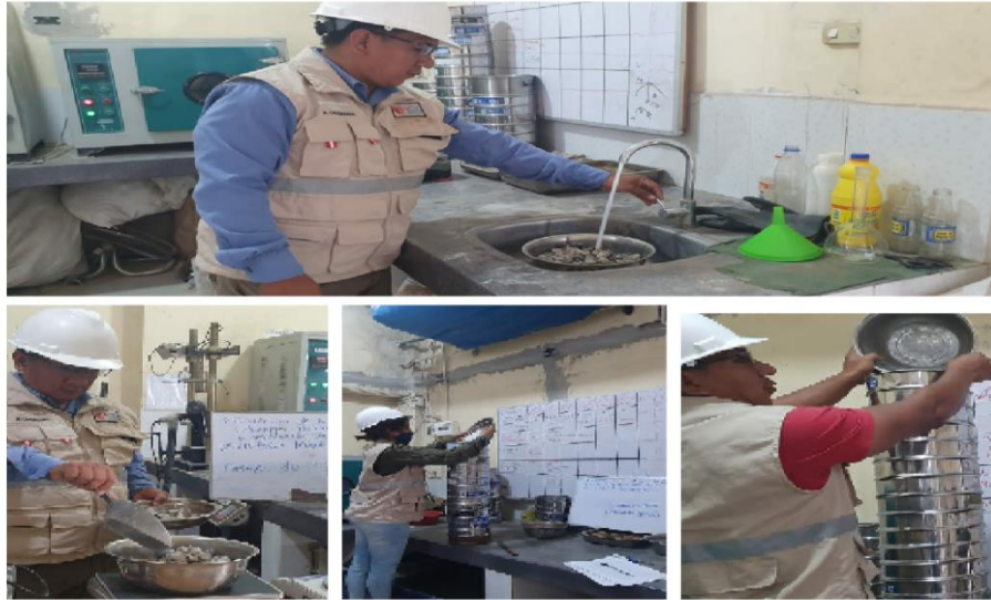
Procedimiento para el ensayo de análisis granulométrico por tamices Del agregado grueso
