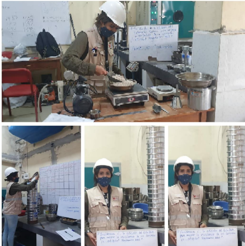
Foto Procedimiento del ensayo granulométrico para el agregado fino
