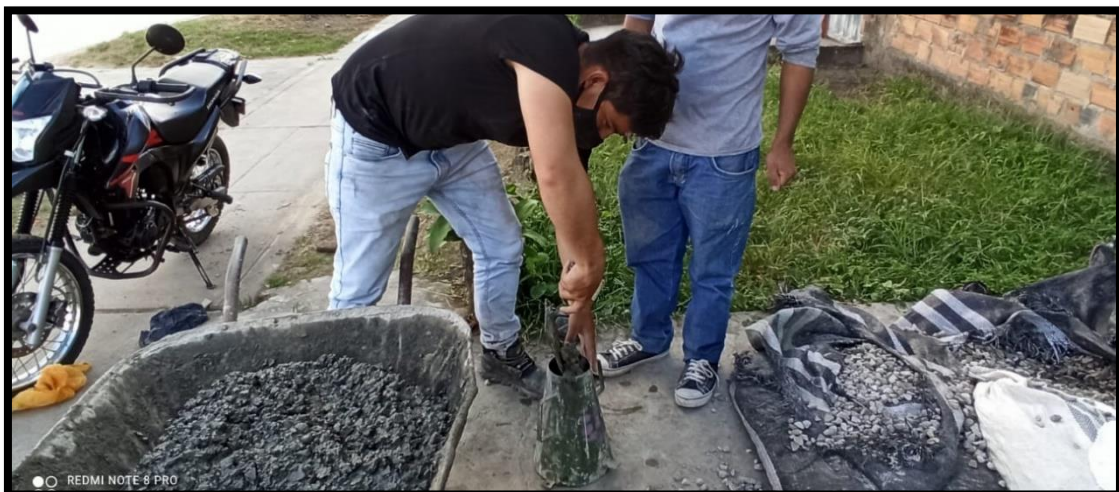
Figura 10. Elaboración del ensayo Slump
