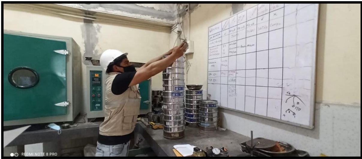
Figura 8. Tamizado de los agregados
