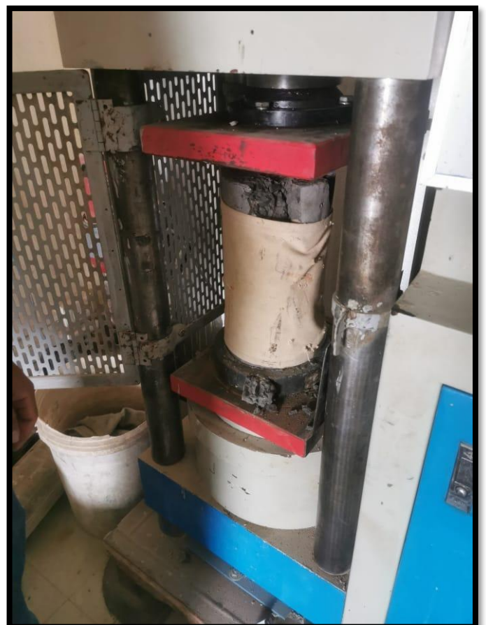
Figura 17. Testigo de concreto luego del ensayo de compresión
