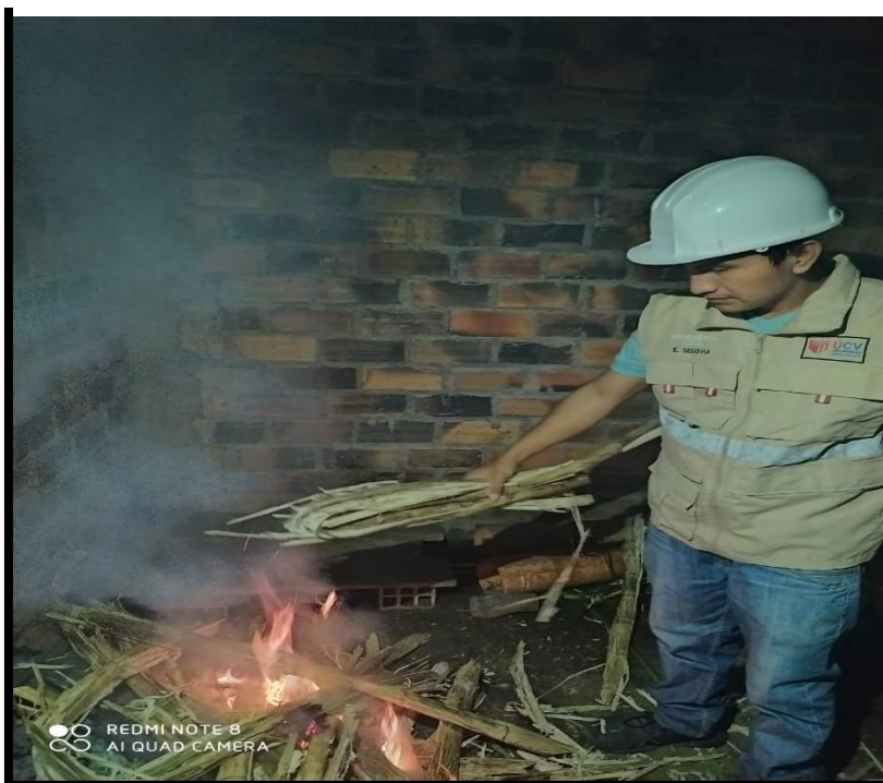
Figura 6. Quemado de bagazo de caña de azúcar para obtención de CBCA
