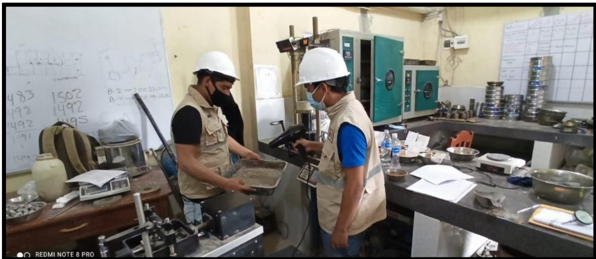
Figura 9. Secado del agregado para verificar el contenido de humedad
