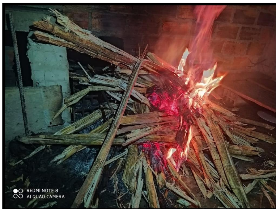
Figura 7. Quemado de bagazo de caña de azúcar para obtención de CBCA
