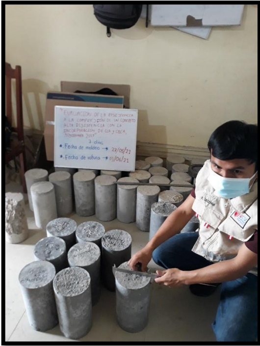
Figura 15. Medición de las dimensiones de los testigos de concreto
