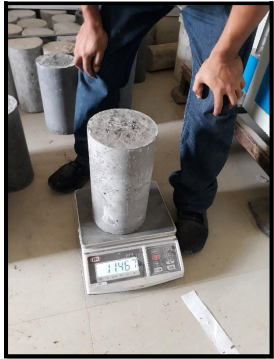
Figura 14. Pesado de los testigos de concreto
