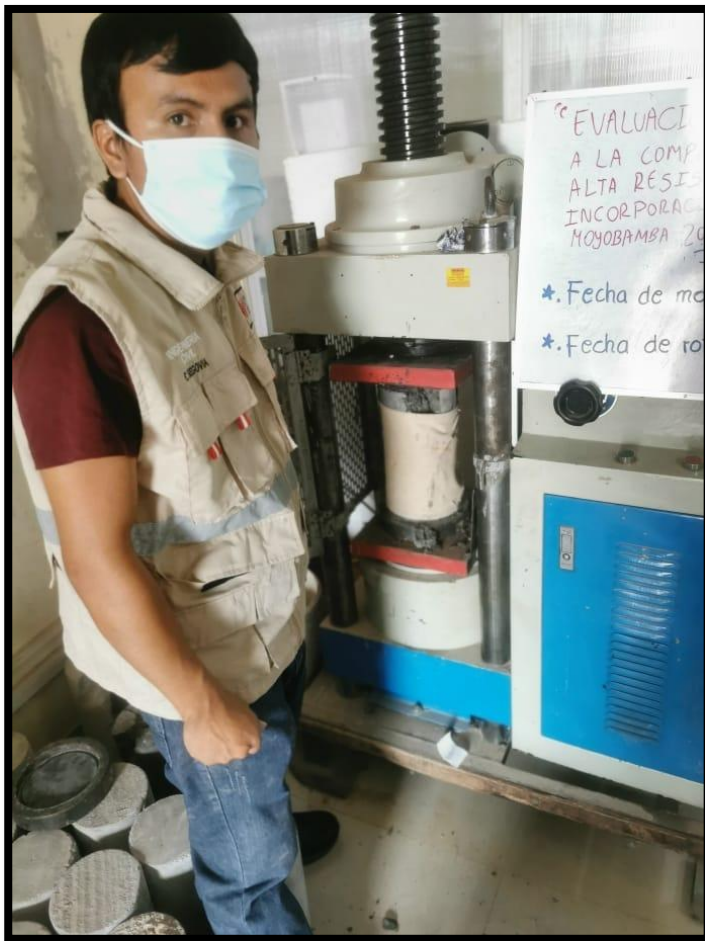
Figura 18. Realizando el ensayo de compresión a los testigos de concreto
