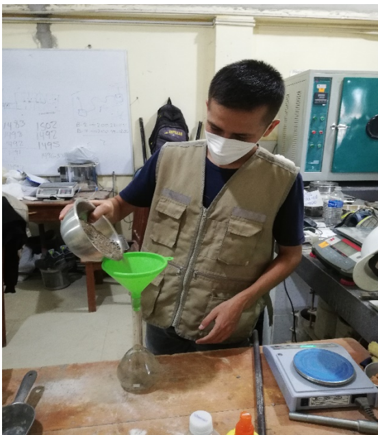
Fotografía N° 07 y 08 contenido de humedad del agregado grueso de acuerdo al ASTM 2216
