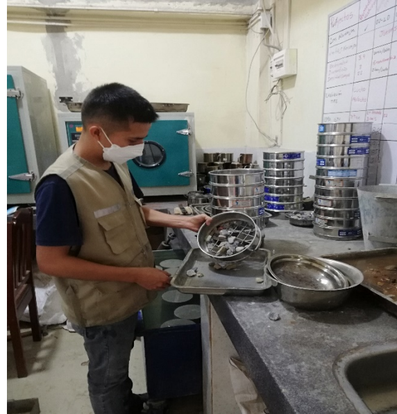
Fotografía N° 11 y 12 peso específico del agregado grueso de acuerdo al ASTM C-127
