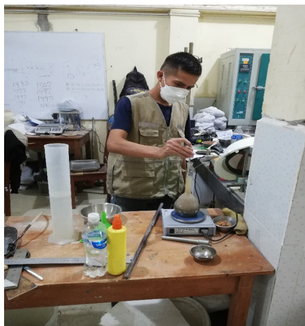
Fotografía N° 07 y 08 contenido de humedad del agregado grueso de acuerdo al ASTM 2216
