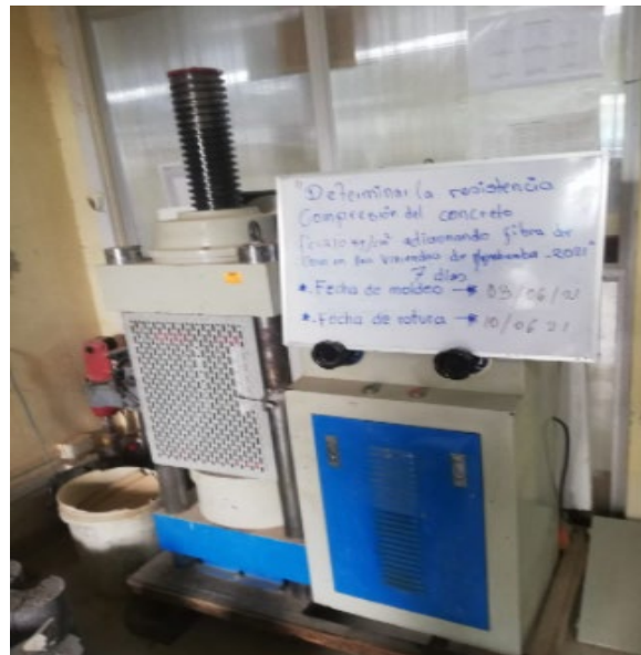
Fotografía N° 15 y 16 ensayo de resistencia a compresión del concreto
