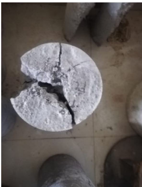
Fotografía N° 15 y 16 resultados de rotura a compresión de las probetas cilíndricas
