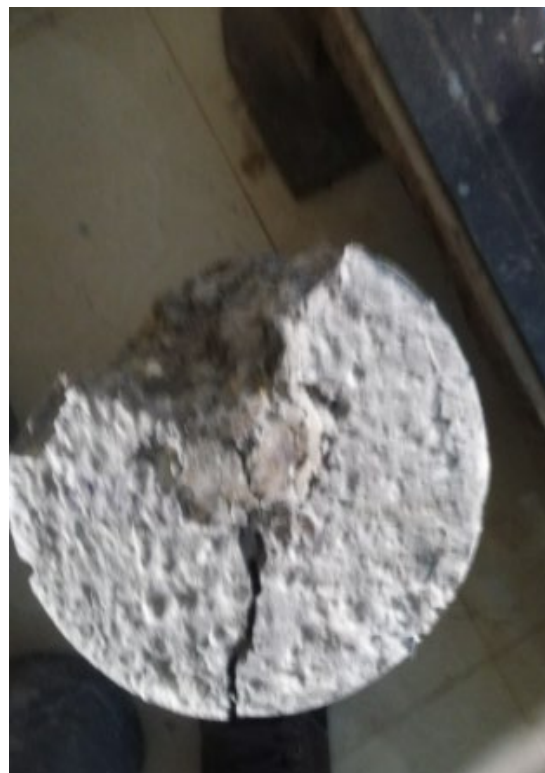
Fotografía N° 15 y 16 resultados de rotura a compresión de las probetas cilíndricas
