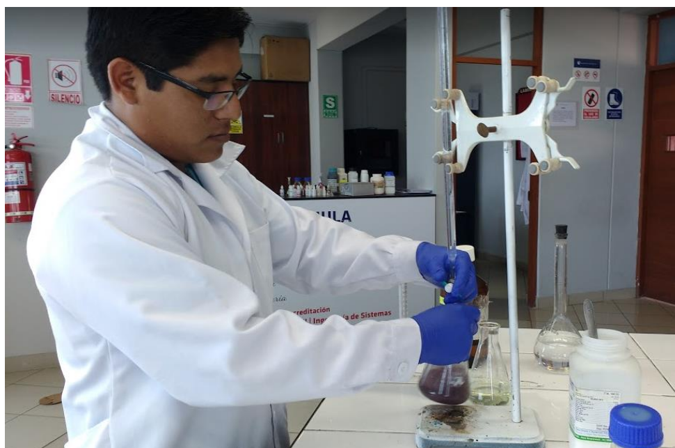
Imagen 15: determinación de la concentración de cromo del efluente de la curtiembre Chimu SAC, por método volumétrico.
