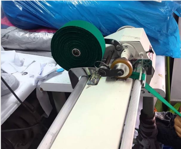
Figura 24. Máquina cortadora de cinta del taller, parte superior
