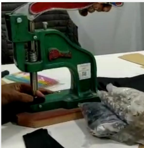
Figura 30. Brochera industrial del taller
