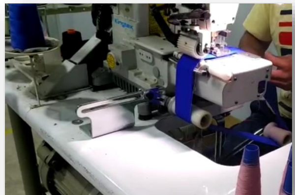
Figura 25. Máquina elasticadora en funcionamiento dentro del taller.
