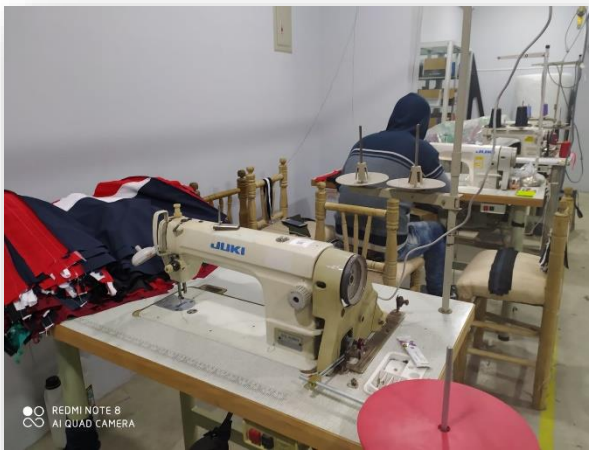
Figura 18. Máquina Recta del taller
