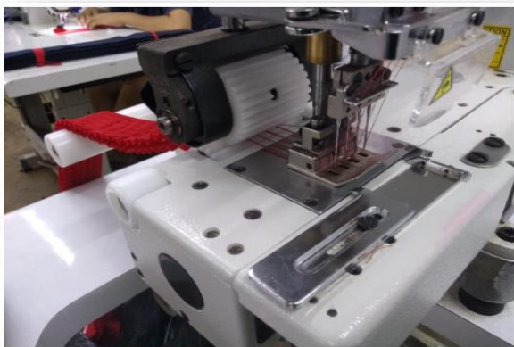
Figura 26. Máquina elasticadora del taller.
