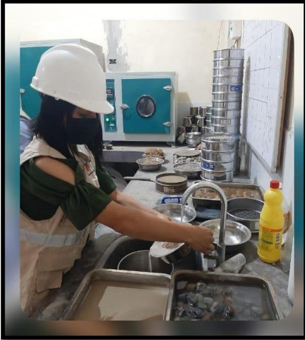
**Fotografía N° 13.** Lavado de muestra por el tamiz N° 200 de agregado grueso para ensayo de granulometría.
