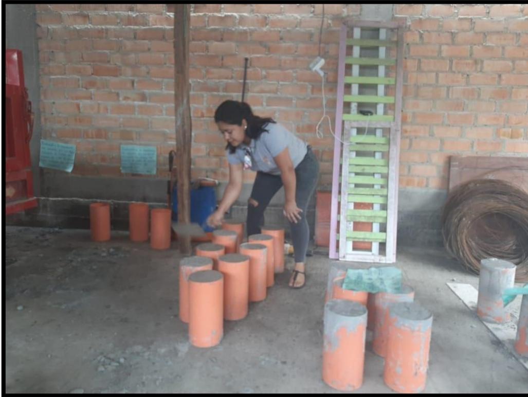
**Figura N° 22 y 23:** Colocación de la mezcla a las probetas.
