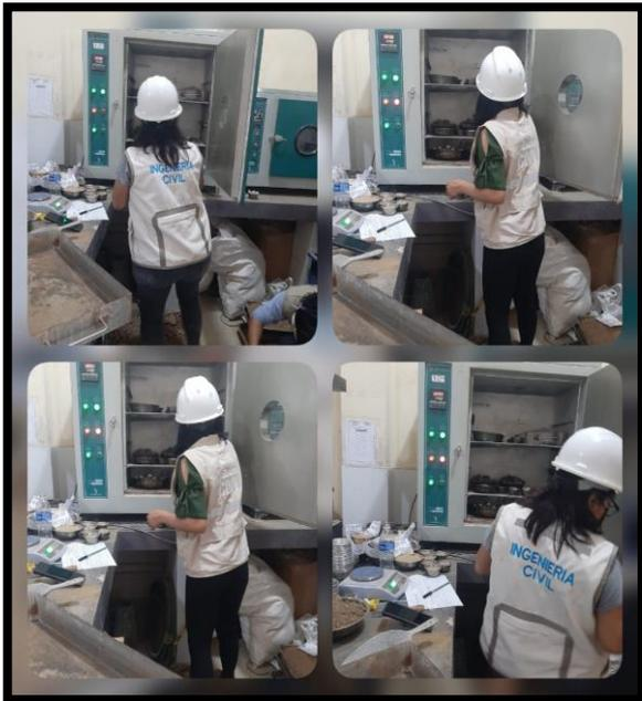
**Fotografía N° 04.** Secado del material al horno de  $110 \pm 5^\circ \text{C}$ .
