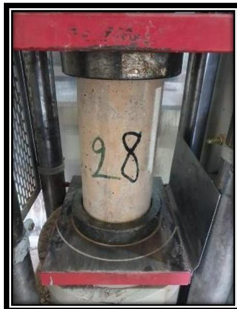
Fotografía N°31 y 32. Prueba de resistencia a la compresión, testigos cilíndricos de concreto a los 28 días.
