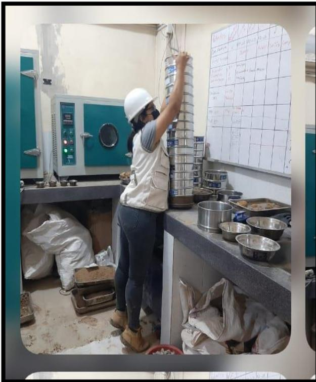
**Fotografía N° 06.** Análisis Granulométrico por Tamizado del Agregado fino.
