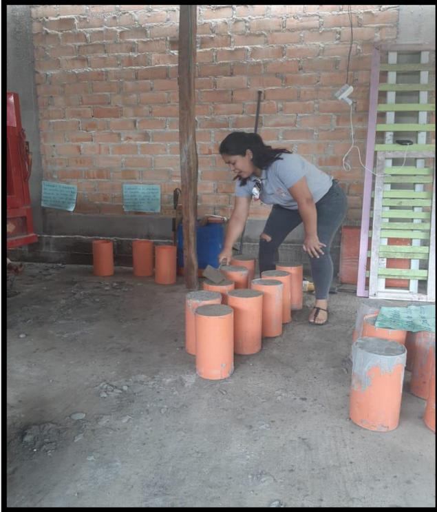
**Figura N° 24 y 25:** Pasada las 24 horas, se pasó a desencofrar las probetas.
