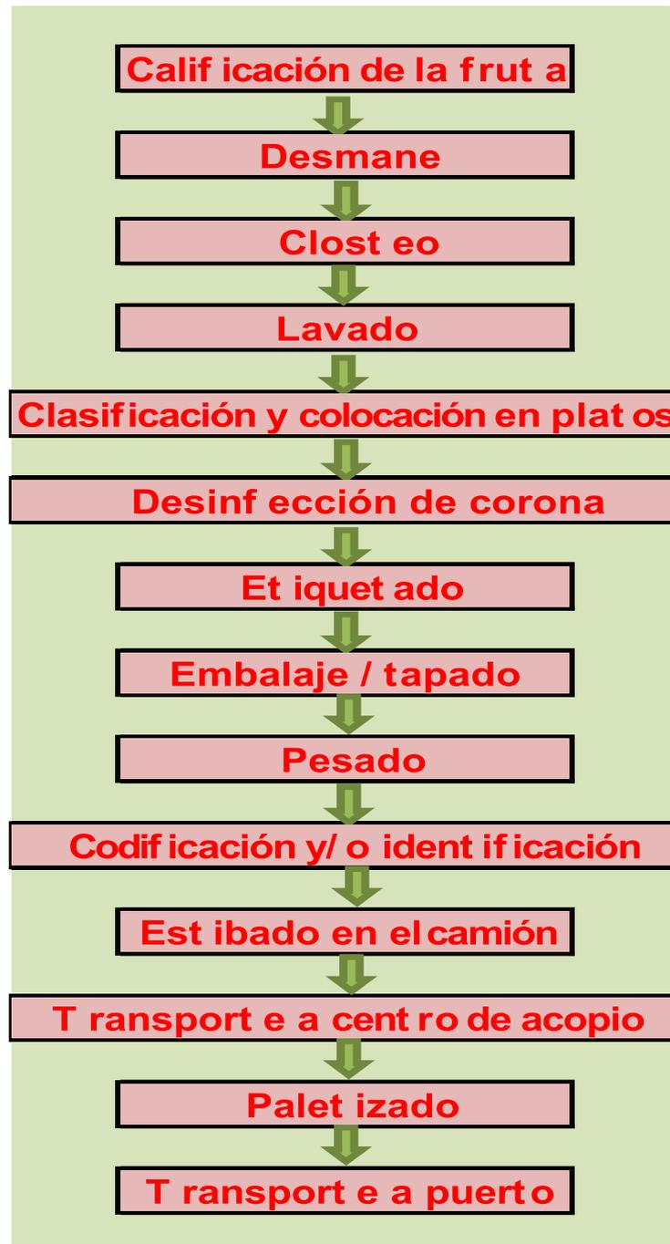
Figura N° 0 2:Flujograma sub etapa Proceso Valor agregado
