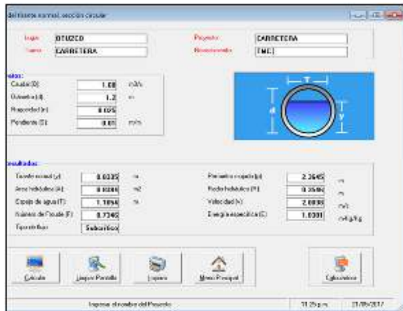
Figura 16. "Dimensión de alcantarilla de paso de 48"
