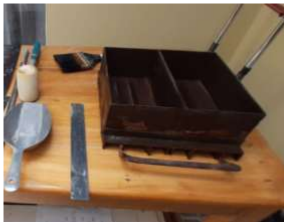
Figura 7 Molde para la producción de los bloques de concreto.
