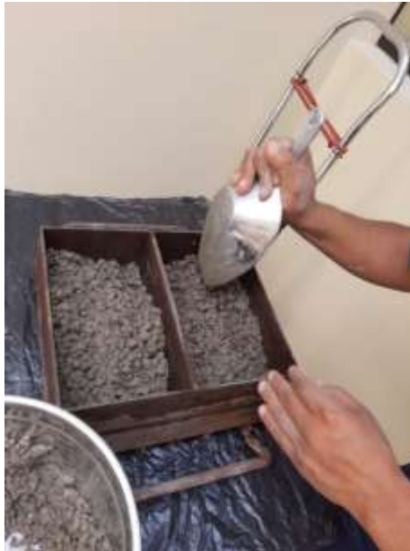
Figura 10 Mezcla añadida al molde de los bloques de concreto con dimensiones 24x13x9
