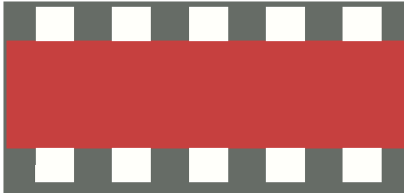
Figura N.º 75: demarcación roja en cruce de ciclovía
