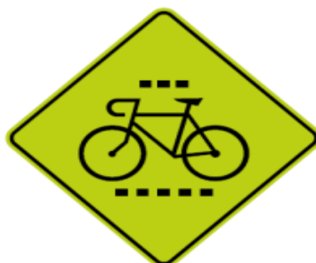
Figura N.º 22: Cruce de ciclista
