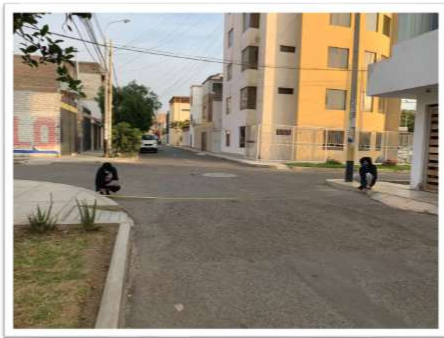
Figura 68: Medición de ancho de calzada.
