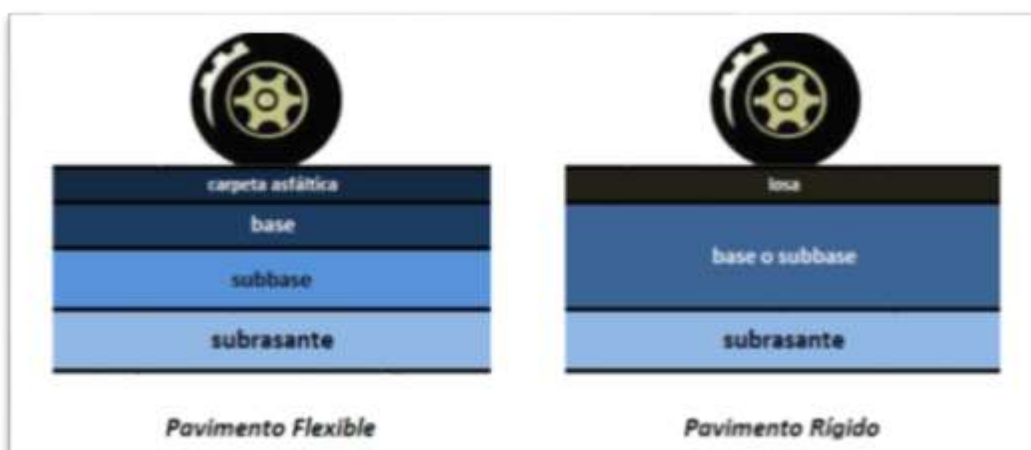
Figura 1: Conformación del pavimento rígido y flexible
