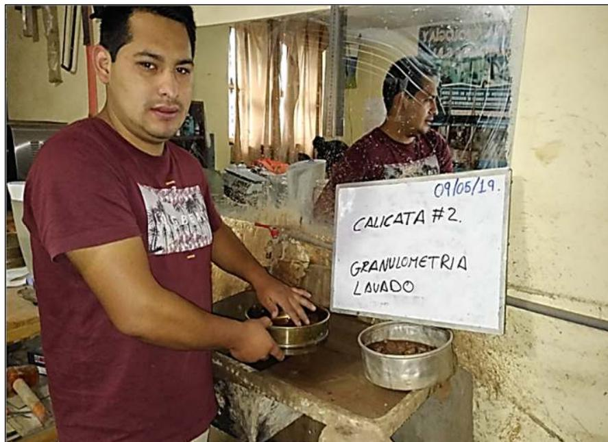
Figura 32. Análisis granulométrico por tamizado - Calicata N°2
