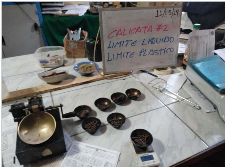
Figura 34. Ensayo de límites de consistencia – Calicata N°02.
