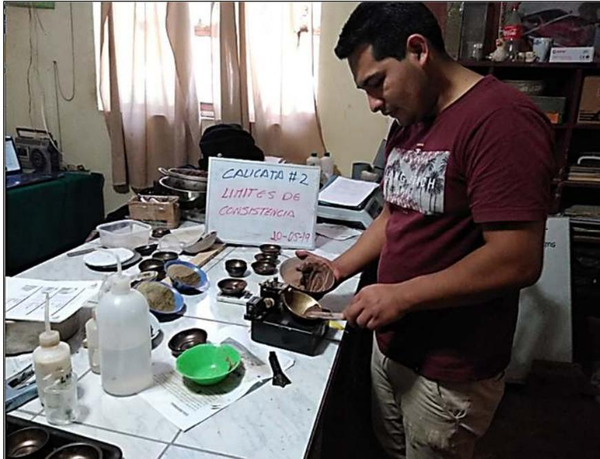
Figura 33. Ensayo de límites de consistencia – Calicata N°01.
