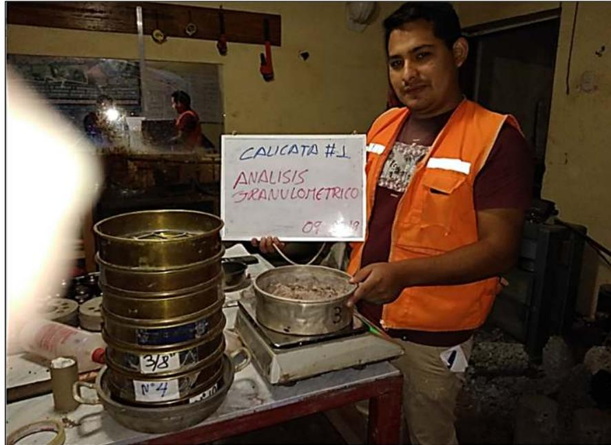
Figura 31. Análisis granulométrico por tamizado, calicata N°1
