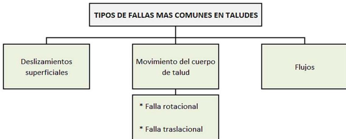
Figura 4. Tipos de fallas en taludes.
