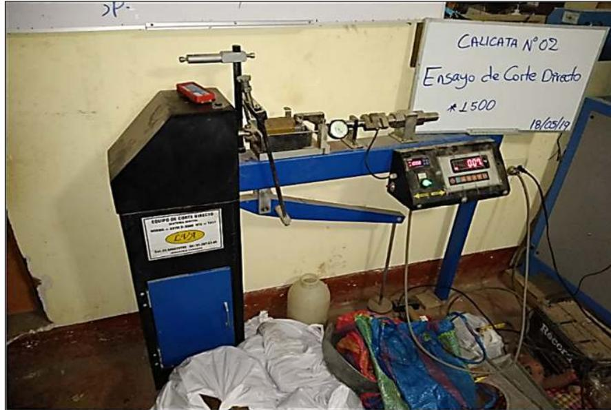
Figura 36. Ensayo de corte directo – Calicata N°02.
