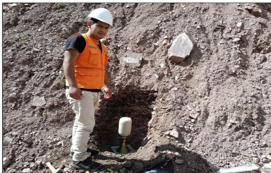
Figura 29. Método del cono de arena in situ – Calicata N°1.
