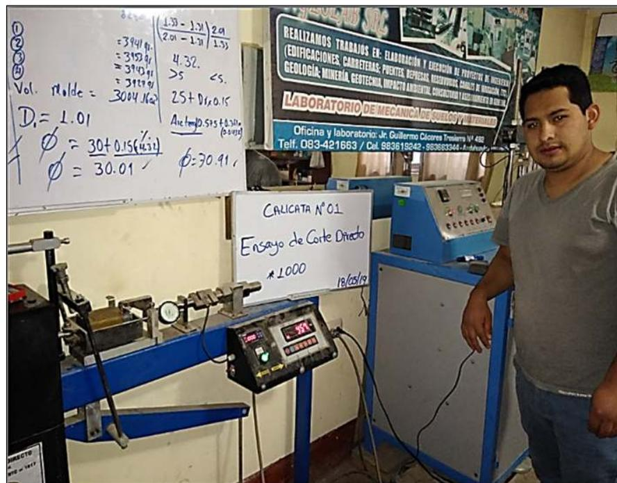
**Figura 35.** Ensayo de corte directo – Calicata N°01.
