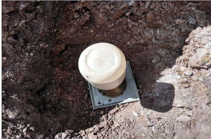
Figura 30. Método del cono de arena in situ – Calicata N°2.
