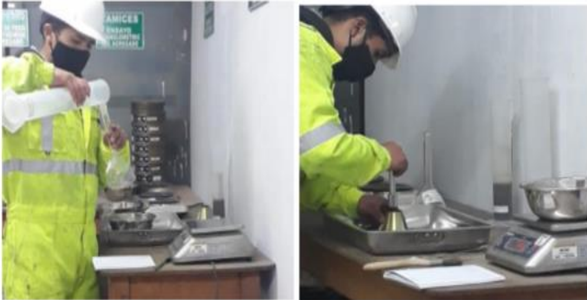
Figura 13. Ensayo de gravedad específica y absorción de agregado.
