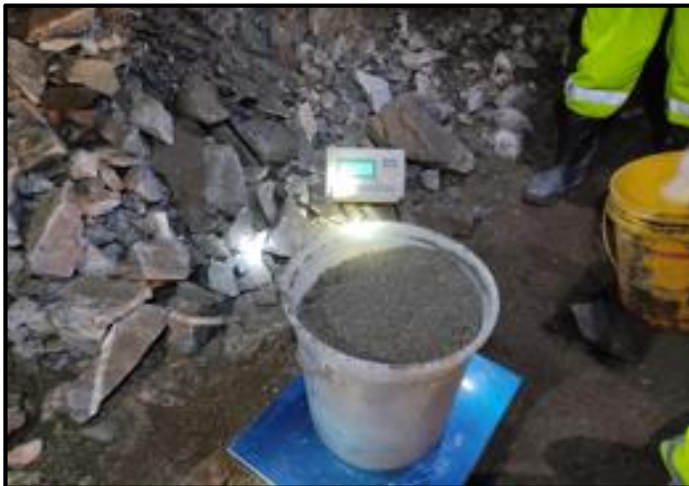
Figura 14. Peso de rebote de shotcrete
