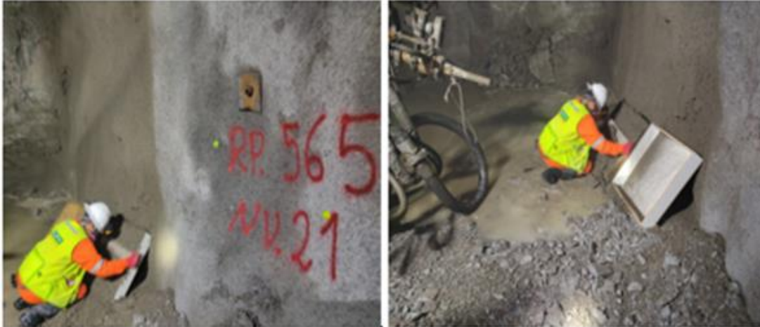
Figura 30. Elaboración de muestras para el ensayo con marittlo hilti DX 450 Fuente: Elaboración propia.
