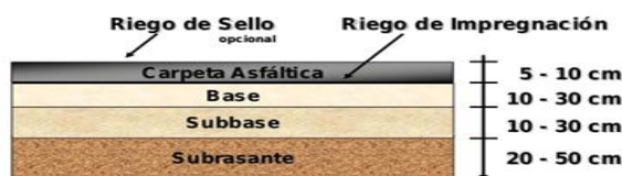
Figura 1 Sección Transversal de pavimento flexible.
