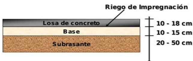
Figura 2: Sección Transversal de pavimento rígido.
