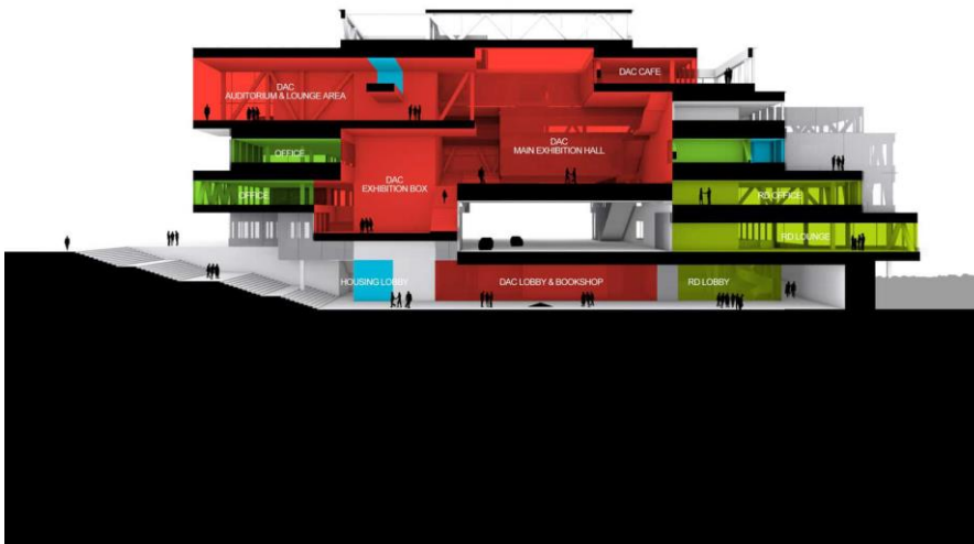
Imagen 02: Diagrama conceptual de yuxtaposición de usos del edificio híbrido, The Blox Fuente: www.oma.com
