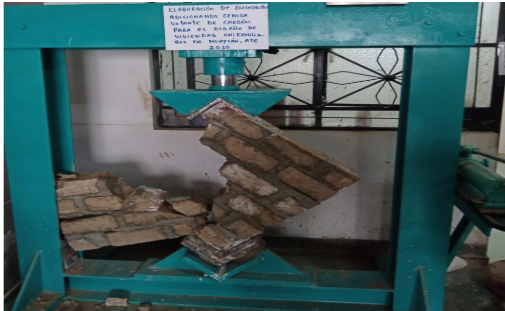
Figura 64. Ensayo de compresión de muretes.
