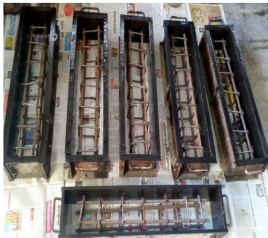
Figura 8: Vigas de bambú
