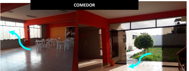
En el caso del comedor, si cuenta con ventilación cruzada, por lo cual este ambiente se encuentra suficientemente ventilado.
