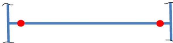
Figura 92. Longitud plástica en elementos viga, Hospital Regional de Lambayeque.
