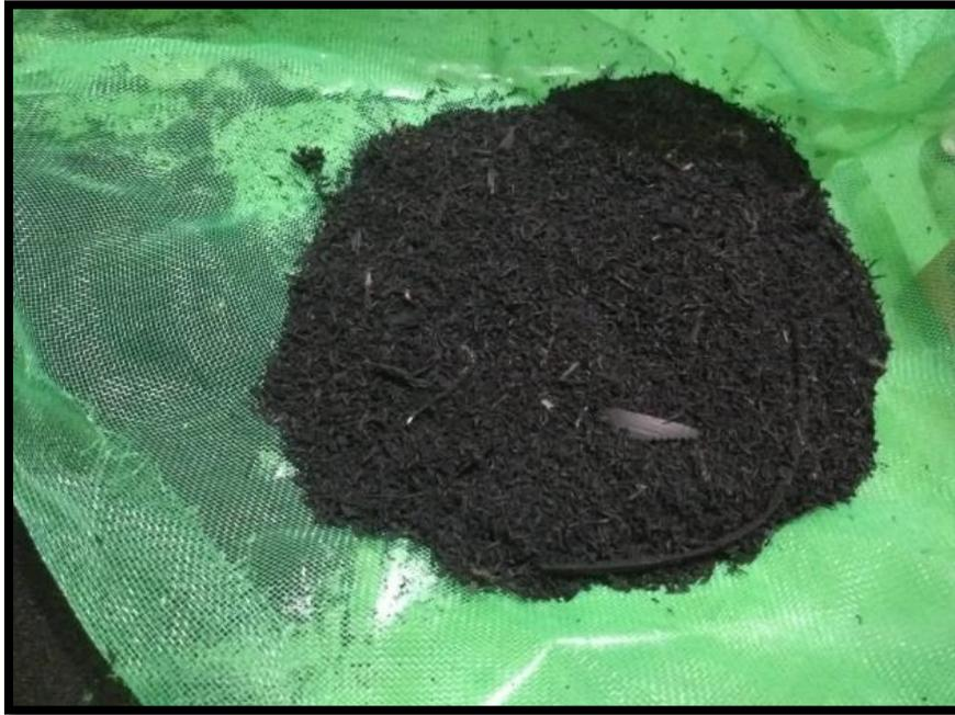
**Figura N° 11. Residuos del caucho luego del tamizado**
