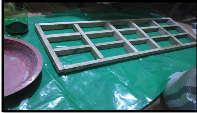
**Figura N°9. Molde de madera para la elaboración de adoquines**
