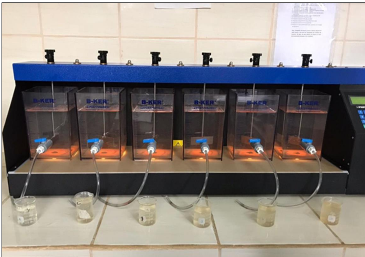
Ensayo de test de jarras concluido, aplicación de coagulante y coadyuvante
