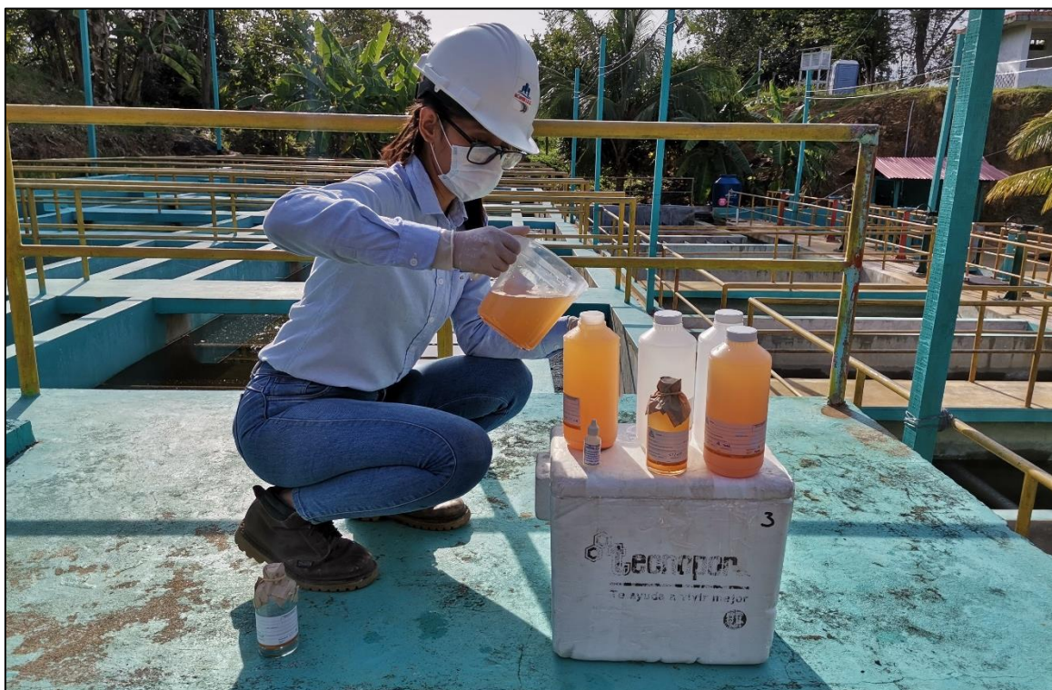
Muestreo de agua en la entrada a la planta de tratamiento
