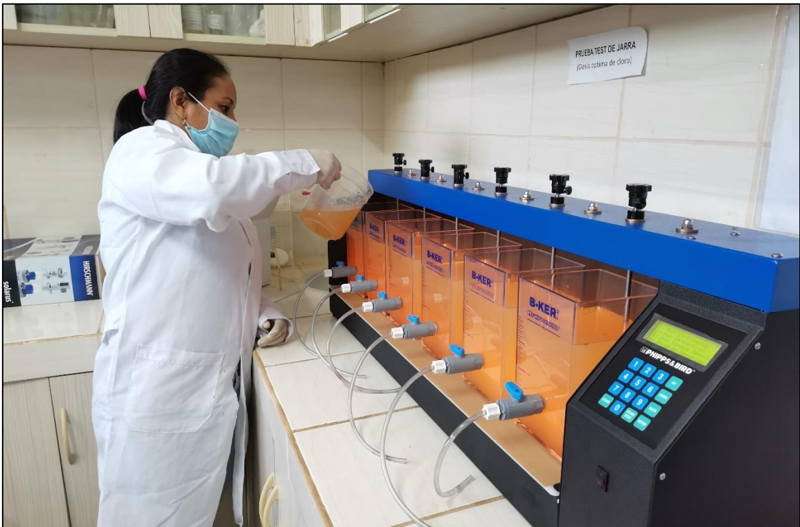
Adición de la muestra bruta a cada una de las jarras del Test Fuente: Elaboración propia, 2021.
