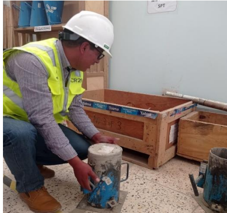
Figura 26. Desencofrado de briquetas
