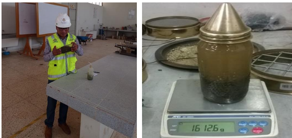
Figura 15. Ensayo de absorción de los agregados
