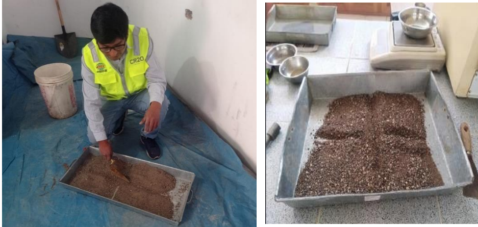
Figura 22. Mezcla de la conminución del concreto con el agregado fino
