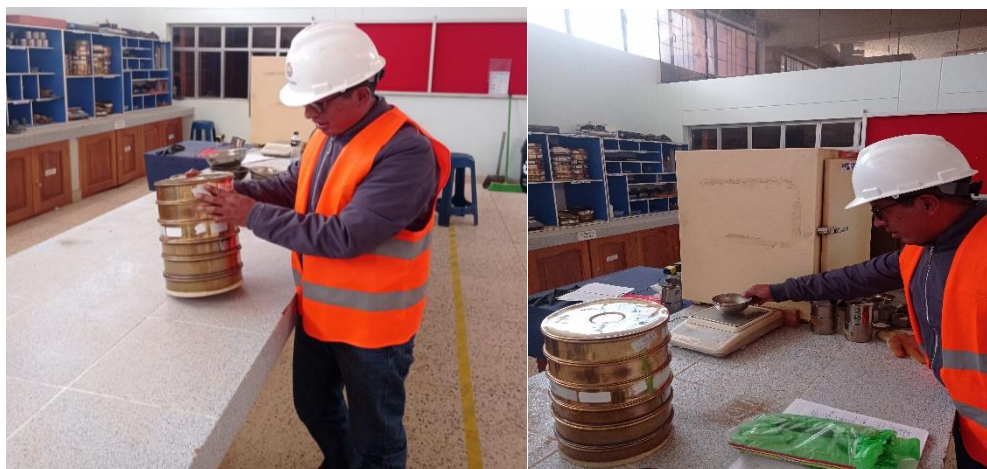
Figura 19. Ensayo de granulometría
