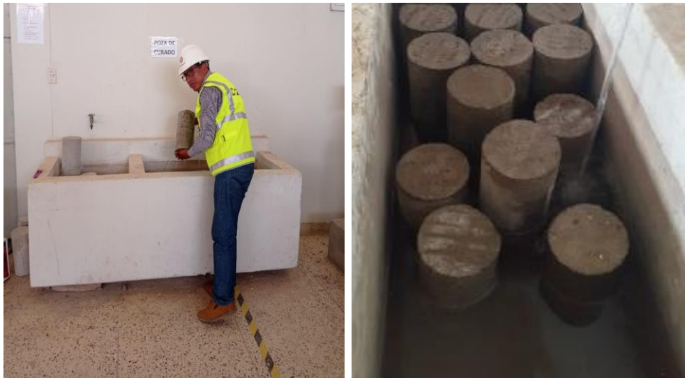
Figura 27. Curado de briquetas
