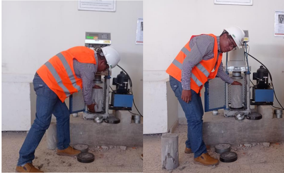
Figura 28. Rotura de briquetas en máquina de compresión axial
