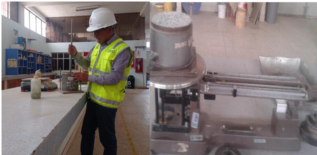
Figura 18. Ensayo de peso específico del agregado
