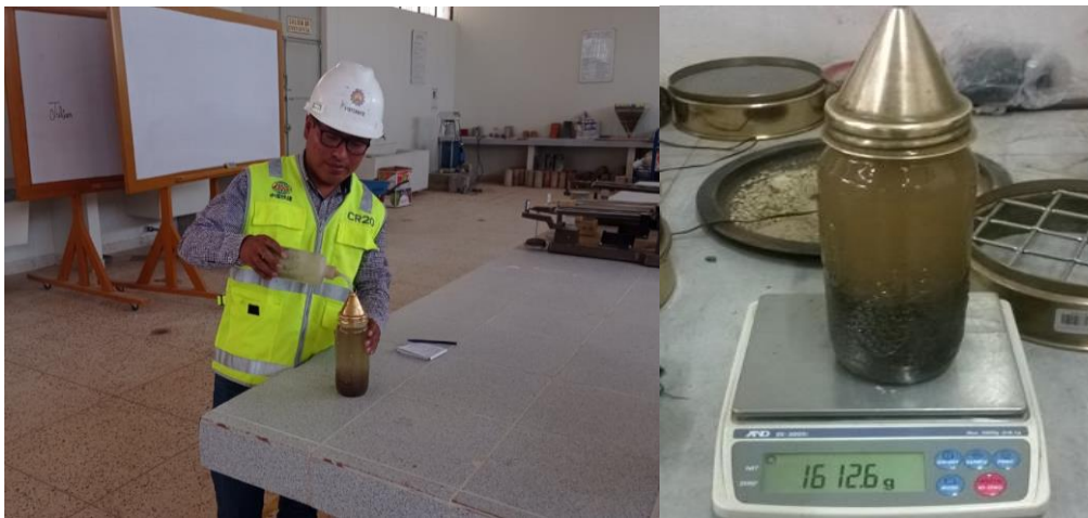
Figura 17. Ensayo de absorción del agregado
