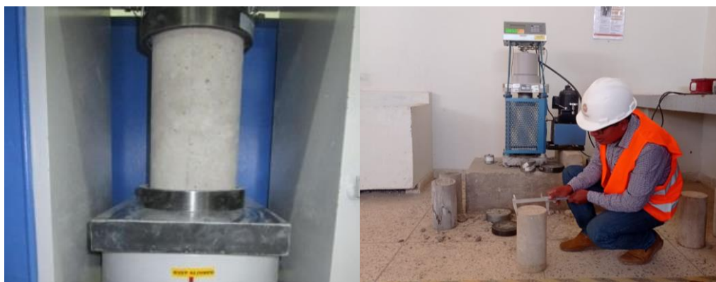
Figura 13. Ensayo de resistencia a la compresión
