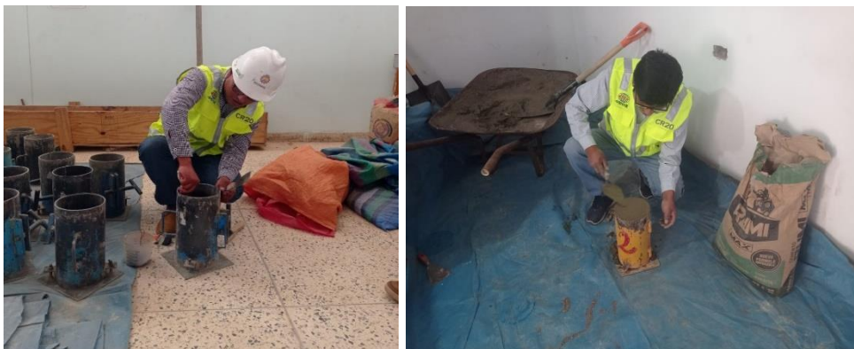
Figura 25. Vaciado de briquetas
