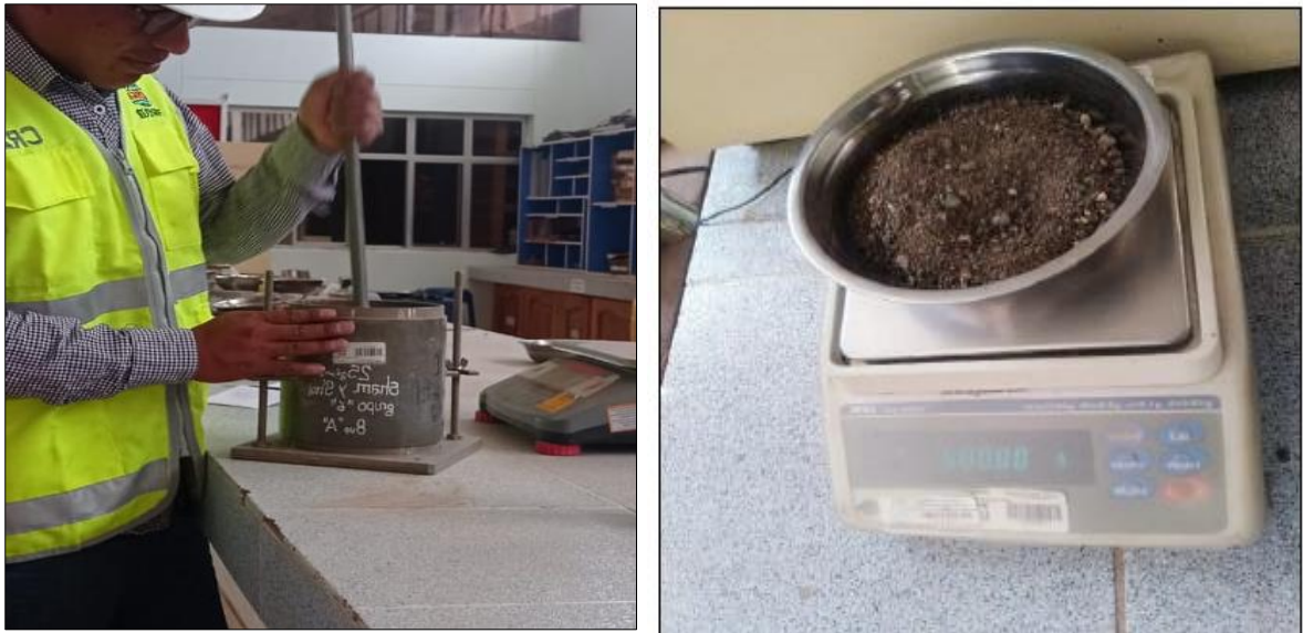
Figura 14. Ensayo para peso específico de los agregados
