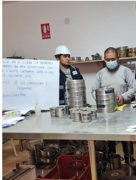
Se observa la entrega se observa los trabajos con las mallas nro 8 a la malla nro 200 ,T-0.1, T-02, C-01 en el laboratorio JR GEO SONSULTORES E INGENIEROS.
