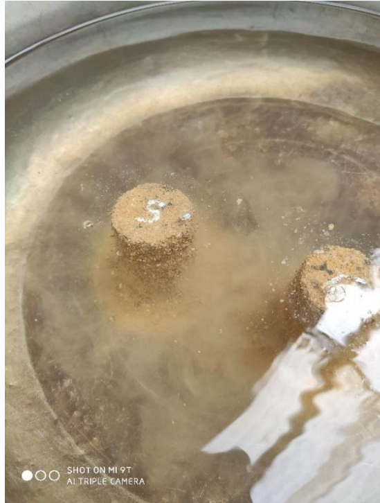
Se observa los testigos sumergidos en agua por 4 horas (material natural) en el laboratorio JR GEO SONSULTORES E INGENIEROS.
