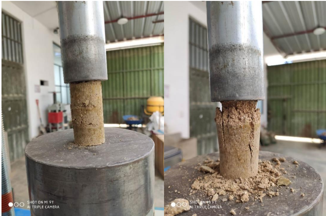
Se observa la compresión y falla de los testigos en el laboratorio JR GEO CONSULTORES E INGENIEROS.
