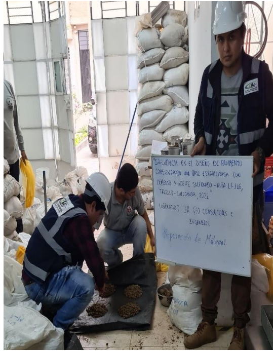
Se observa la preparación y el cuarteo de los materiales T-0.1, T-02, C-01 en el laboratorio JR GEO SONSULTORES E INGENIEROS.
