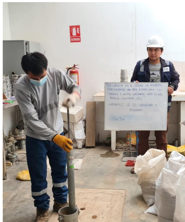
Se observa los trabajos de golpes de pison por capas de T-0.1, T-02, C-01 en el laboratorio JR GEO SONSULTORES E INGENIEROS.
