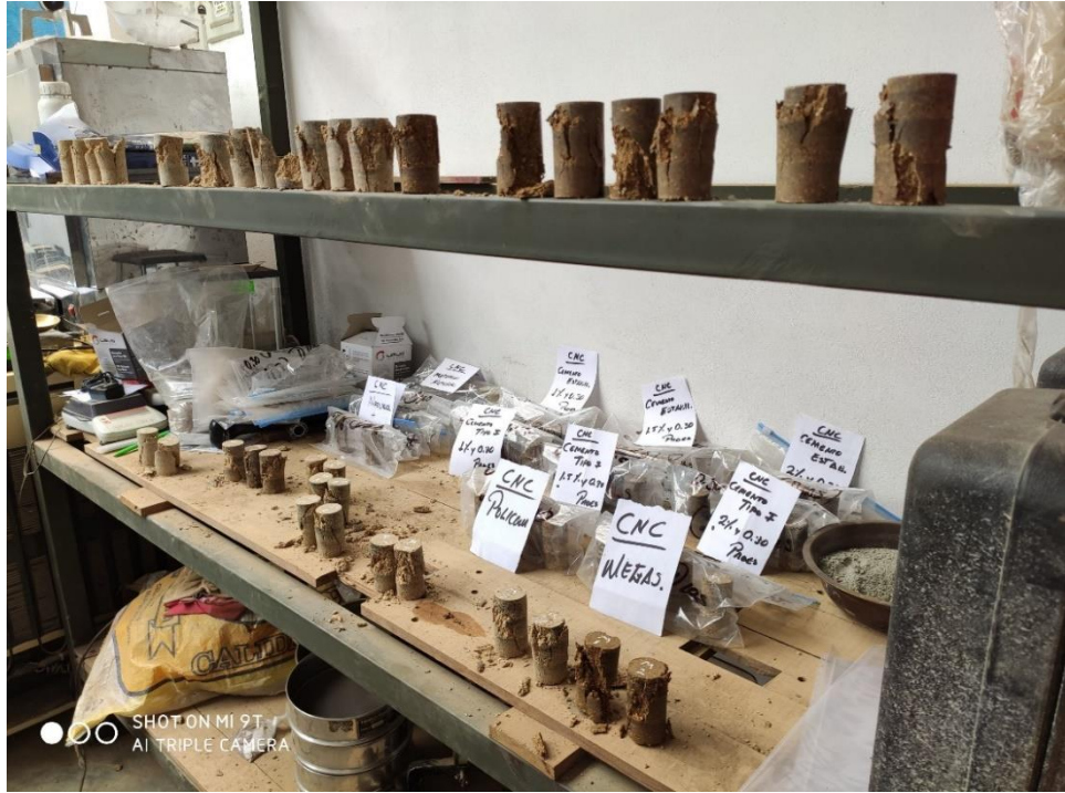
Se observa los testigos fallados testigos en curado a 28 días en el laboratorio JR GEO SONSULTORES E INGENIEROS.
