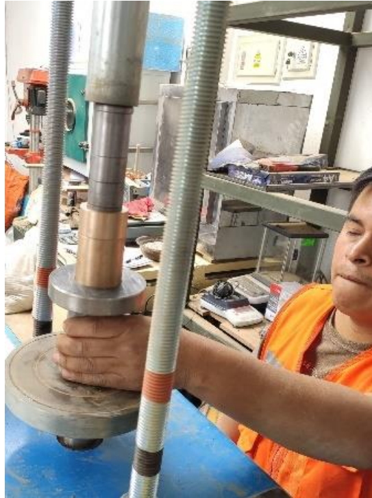
Se observa la extracción del testigo CNC en el laboratorio JR GEO SONSULTORES E INGENIEROS.
