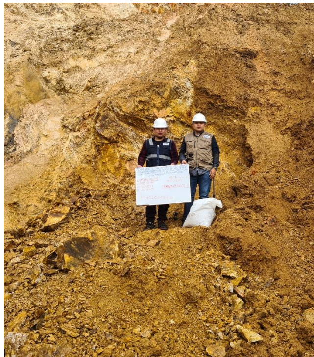
Se observa en la cantera salome el recojo de la muestra trinchera T-01 donde se ve presencia la presencia de grava, color marrón claro, con presencia de fragmentos de roca de tipo subangular de hasta 6".
