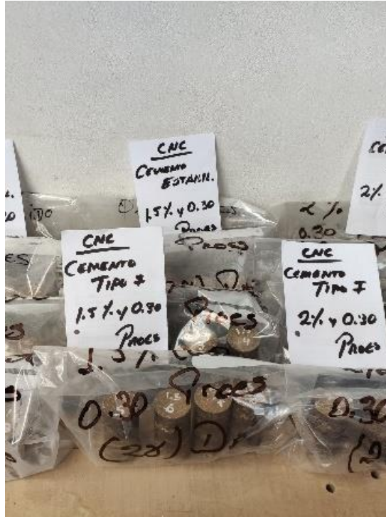
Se observa los testigos CNC en curado por 7 y 28 días según norma, en el laboratorio JR GEO SONSULTORES E INGENIEROS.
