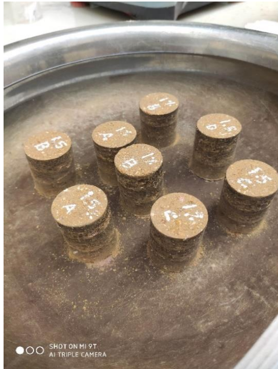
Se observa los testigos sumergidos en agua por 4 horas (cemento estabilizador y proes) en el laboratorio JR GEO SONSULTORES E INGENIEROS.
