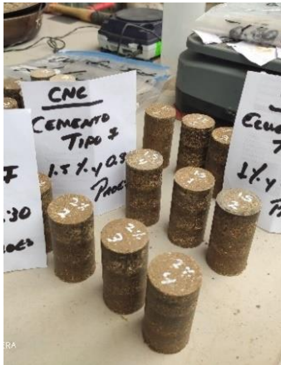
Se observa los testigos curados a 07 días (sin saturar con aditivo proes) en el laboratorio JR GEO SONSULTORES E INGENIEROS.
