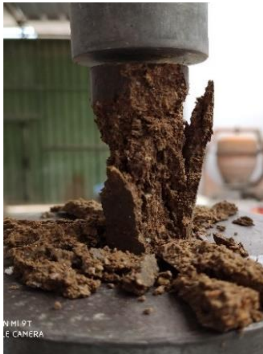
Se observa la compresión y falla de los testigos en el laboratorio JR GEO CONSULTORES E INGENIEROS.
