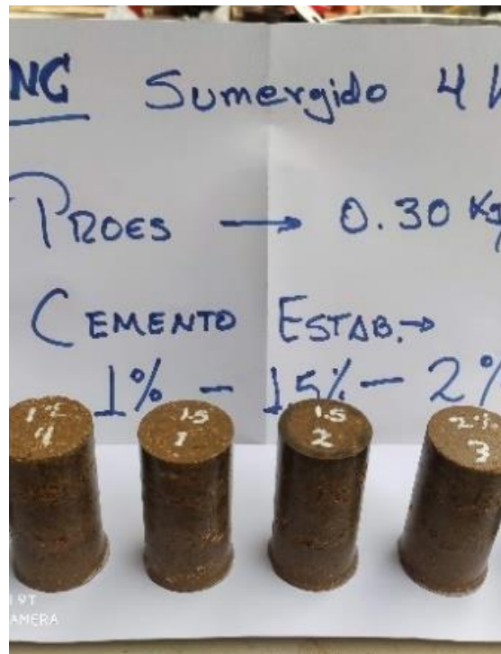
Se observa los testigos curados a 07 días (saturado con aditivo proes) en el laboratorio JR GEO SONSULTORES E INGENIEROS.
