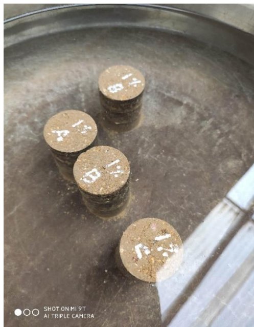
Se observa los testigos sumergidos en agua por 4 horas (cemento tipo I y proes) en el laboratorio JR GEO SONSULTORES E INGENIEROS.
