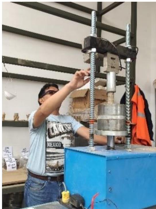
Se observa la rotura de los testigos en el laboratorio JR GEO SONSULTORES E INGENIEROS.
