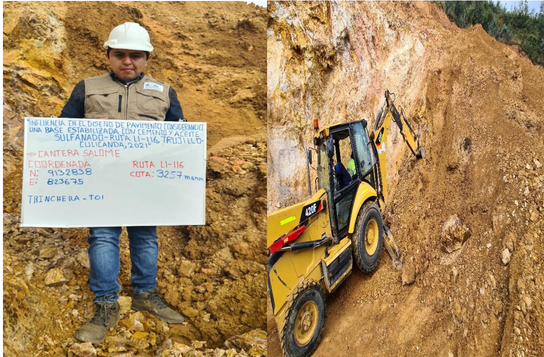
Se observa en la cantera salome la excavacion y recojo de muestra de la trinchera t-01 donde se con presencia de grava limosa.
