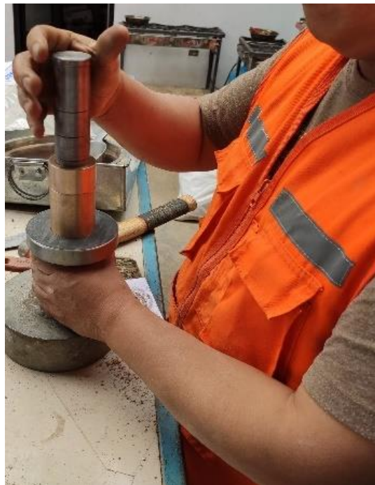
Se observa la compactación del molde CNC en el laboratorio JR GEO SONSULTORES E INGENIEROS.
