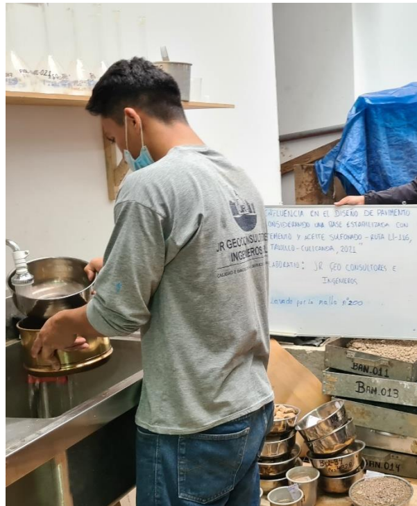
Se observa el lavado de la muestra por la malla nro. 200 T-0.1, T-02, C-01 en el laboratorio JR GEO SONSULTORES E INGENIEROS.
