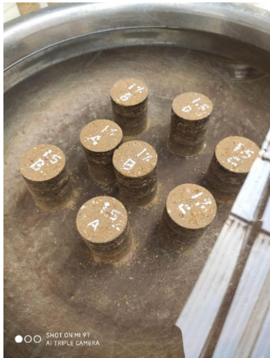
Se observa los testigos sumergidos en agua por 4 horas en el laboratorio JR GEO SONSULTORES E INGENIEROS.
