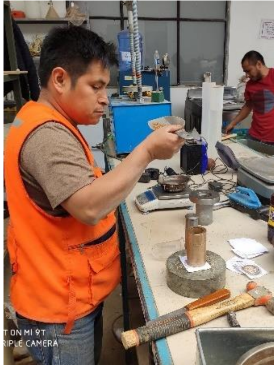
Se observa el pesado del material para molde en el laboratorio JR GEO SONSULTORES E INGENIEROS.
