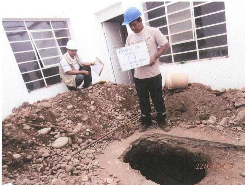
**FOTO N° 11:** Vista panorámica exterior de la excavación a cielo abierto denominado calicata C-3.
