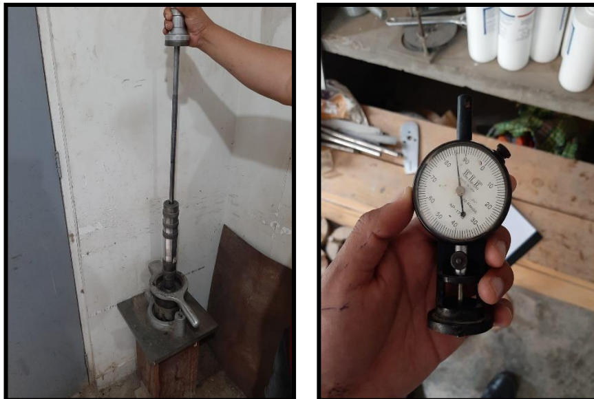
Figura N°7. Martillo de compactación y medidor de Flujo.
