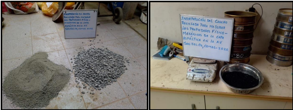
Figura N°6. Agregados pétreos de la mezcla.
