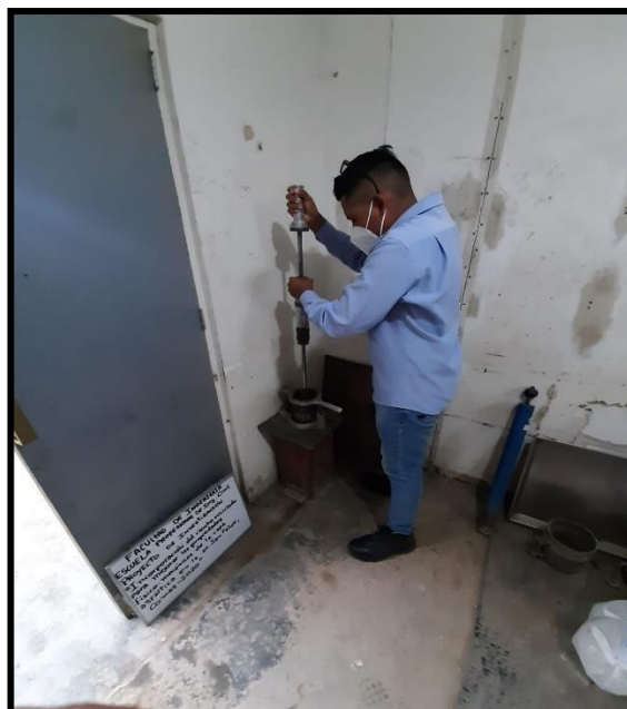
Figura N°11. Preparación de la briqueta 75 golpes
