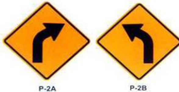
Figura 22. Señal de curva pronunciada a la percha y a la izquierda.
