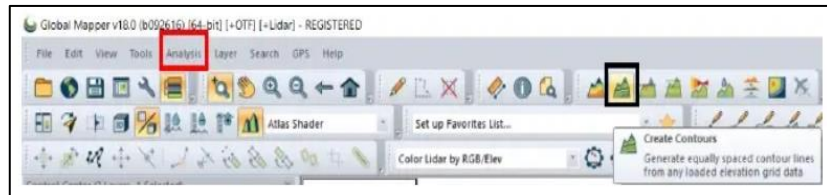
Figura 48. Creación de curvas de nivel en Global Mapper.
