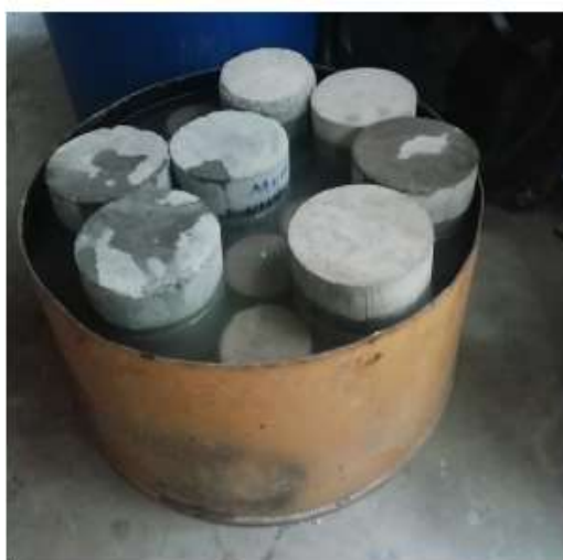
Imagen 2. Ensayo de absorción - Fuente propia
