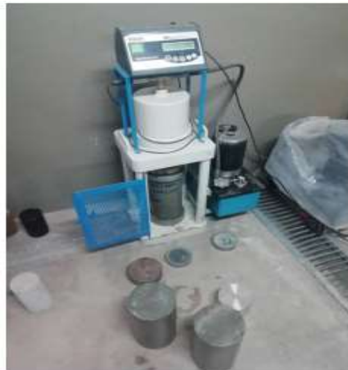
Imagen 1. Ensayo de compresión - Fuente propio
