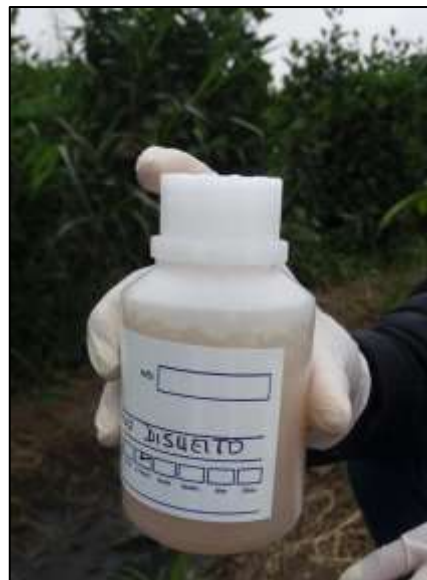
Figura 2213. Muestra de OD con reactivos incorporados
