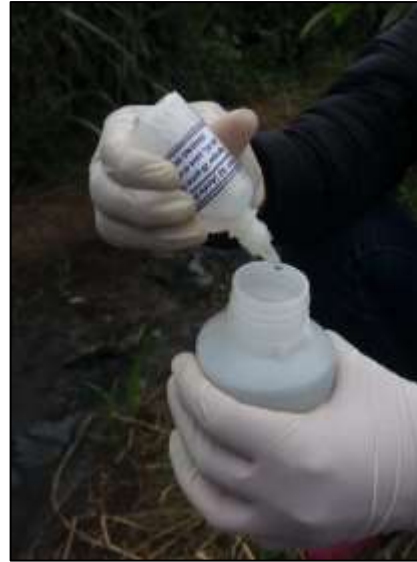
Figura 20. Muestra de OD con Sulfato de Manganeso
