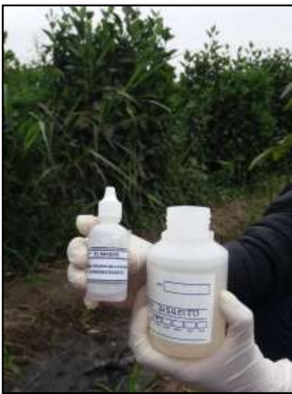
Figura 21. Muestra de OD con Azida de Sodio
