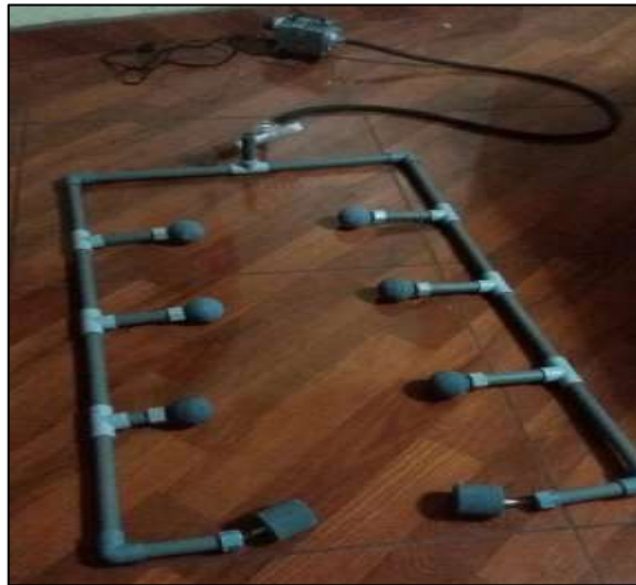
Figura 29. Generador de oxígeno
