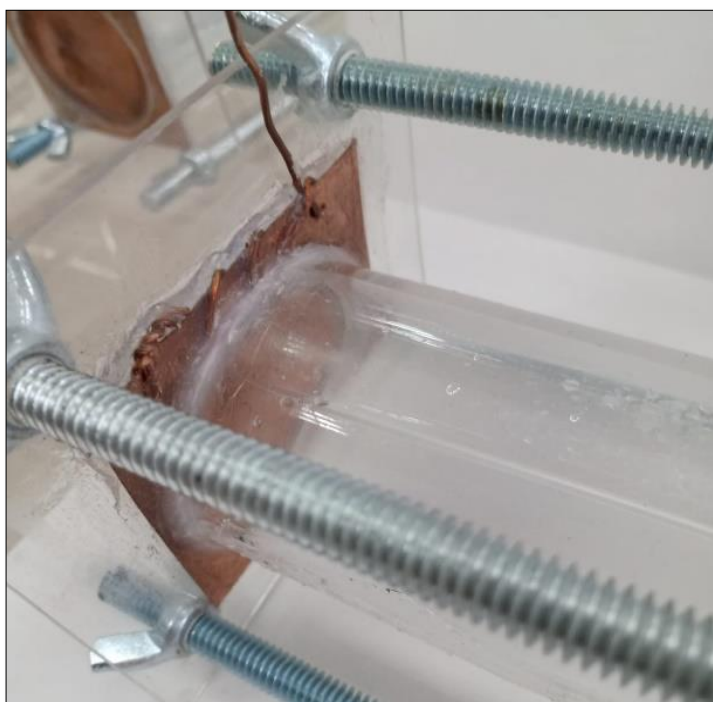
Figura 14. Estructura interna del cátodo de las CCMs
