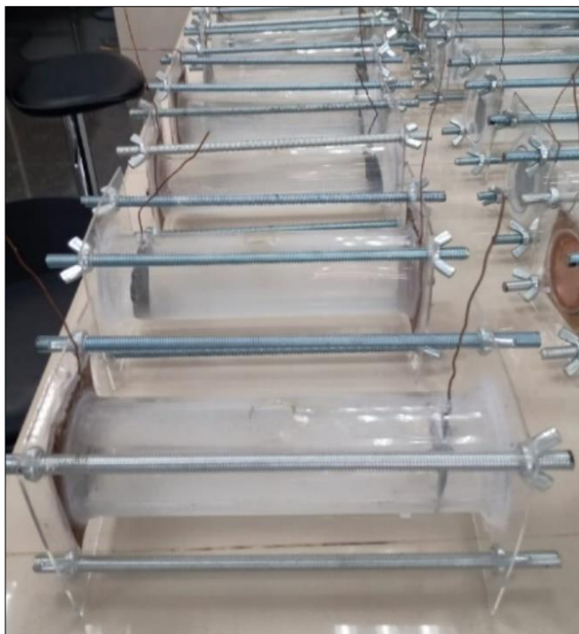
Figura 13. Visualización de la estructura de las CCMs
