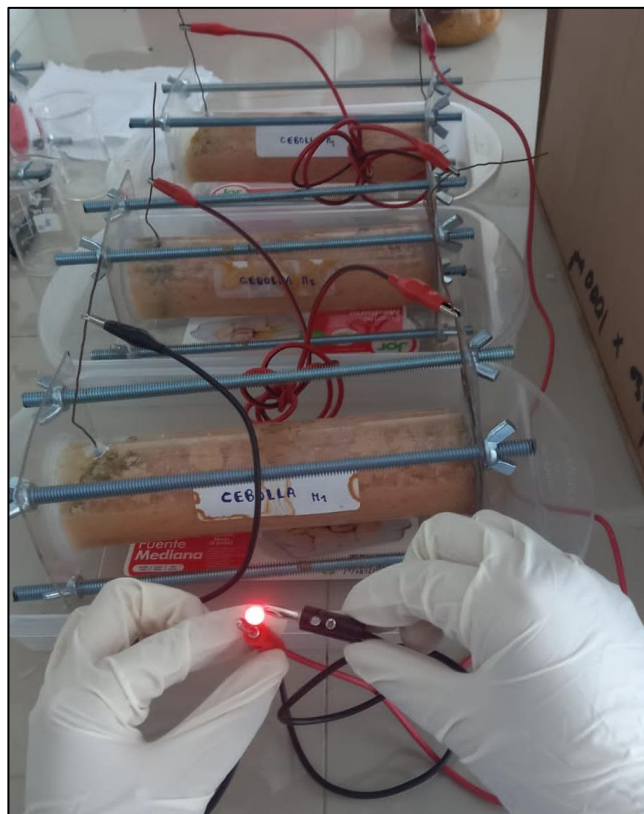
Figura 18. Celdas de combustible microbianas con sustrato cebolla
