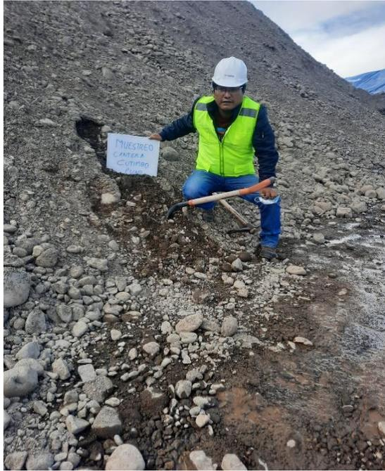
Figura 12. Extracción de muestras cantera cutimbo
