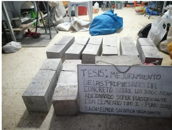
Figura 43. Prismas ensayadas a flexión
