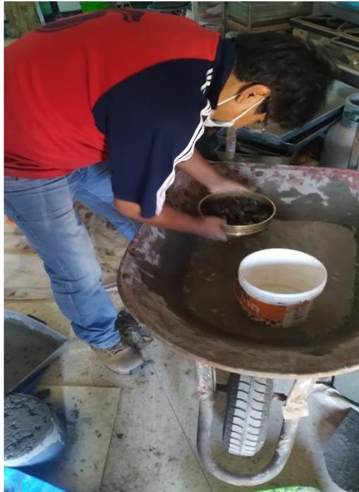
*Figura 32. Lavado de agrado grueso segregado en malla N°04*
