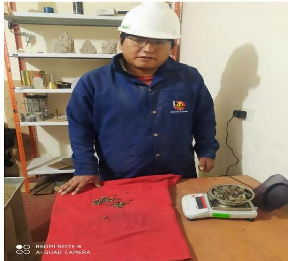
Figura 13. Secado y pesaje de muestra S.S.S.
