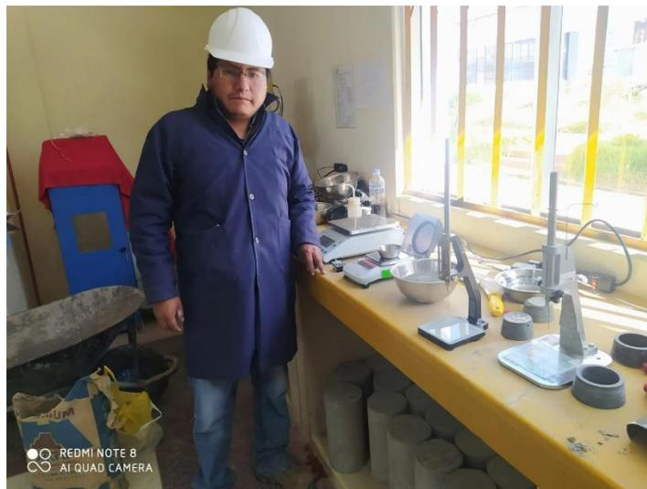
*Figura 28. Preparación de Equipo vicat para ensayo de fragua*
