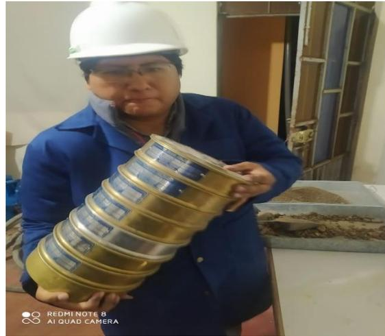
Figura 16. Colocación y tamizado de agregados
