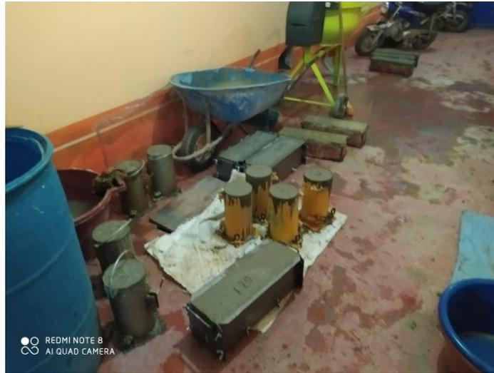
*Figura 18. Probetas cilíndricas y prismáticas moldeadas*
