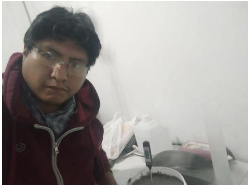
Figura 30. Toma de temperatura del concreto
