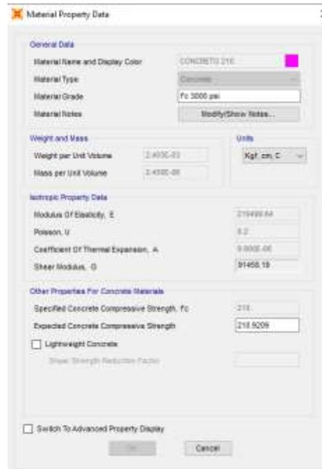
Figura 24. Definición del concreto fc 210 kg/cm<sup>2</sup>
