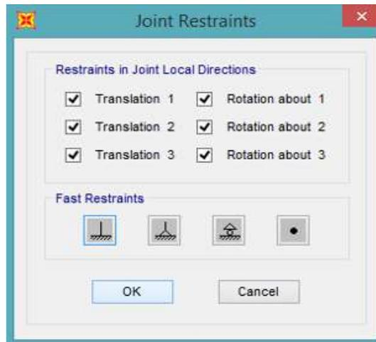
Figura 28. Restricciones de la base rígida
